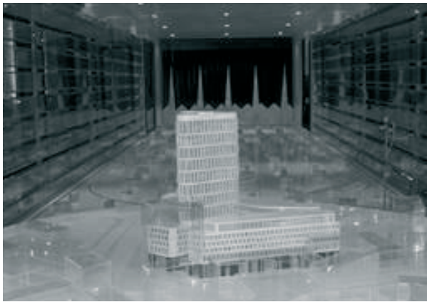
Rys. 2. Model budynku w przestrzeni pomiarowej tunelu aerodynamicznego
