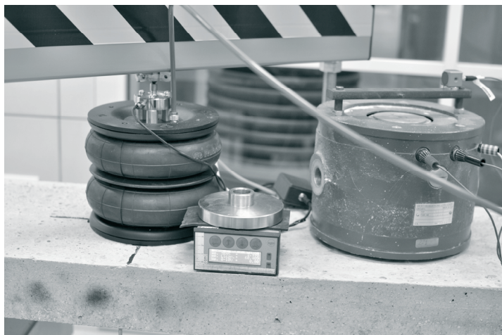
Rys. 2. Poduszka pneumatyczna (po lewej) oraz wzбудnik elektromagnetyczny (po prawej)
