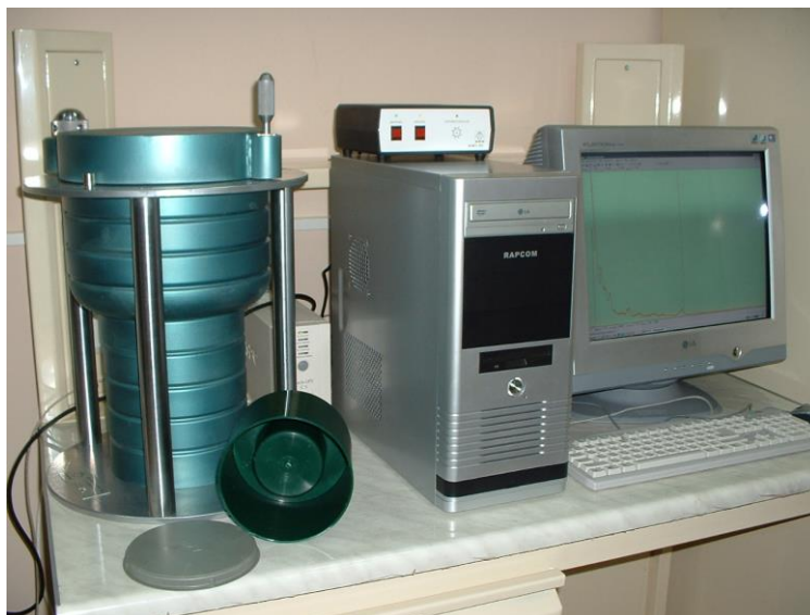
Fig. 1. SEG-001 scintillation gamma spectrometer
