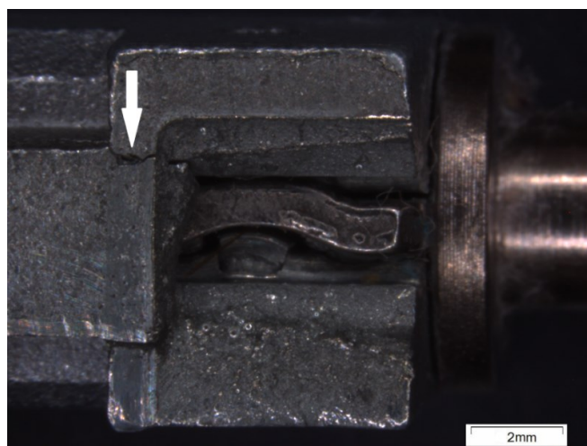
Rys. 6. Makrostruktura powierzchni przelomu z zaznaczonym strzałką pęknięciem. Zdjęcie wykonane na mikroskopie stereoskopowym Nikon SMZ 1500. Źródło: Opracowanie własne
