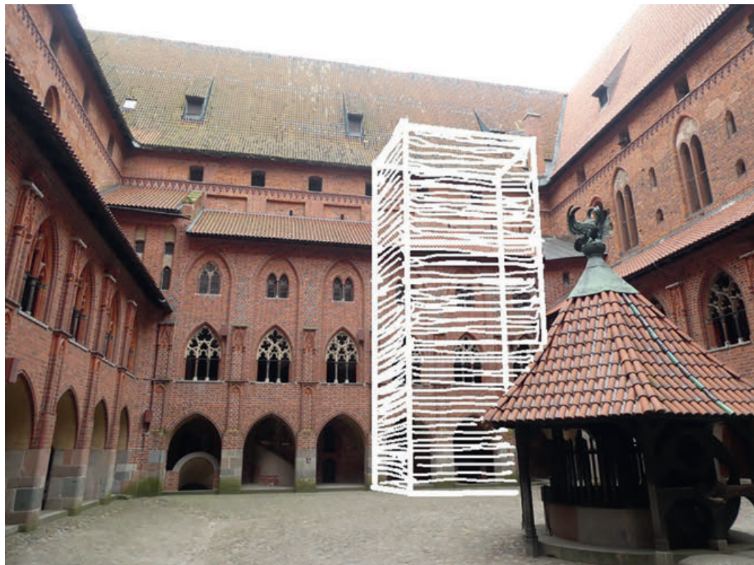
Ryc. 4 Zamek Wysoki w Malborku, dziedziniec. Szkicowa wizualizacja kubatury szymbu mieszczącego dźwąg i klatkę schodową; możliwa do zaakceptowania, oprac. G. Bukal.
