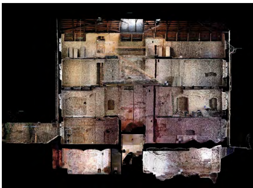
Ryc. 15. Przekrój podłużny modelu 3D wykonanego w technologii skanowania laserowego
