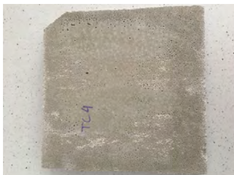
Ryc. 2. Próbka TC4. Tynk perlitowy 341 \text{kg}/\text{m}^3
