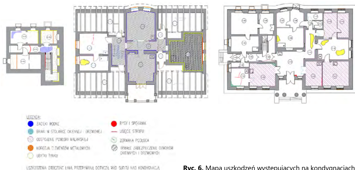
Ryc. 6. Mapa uszkodzeń występujących na kondygnacjach
