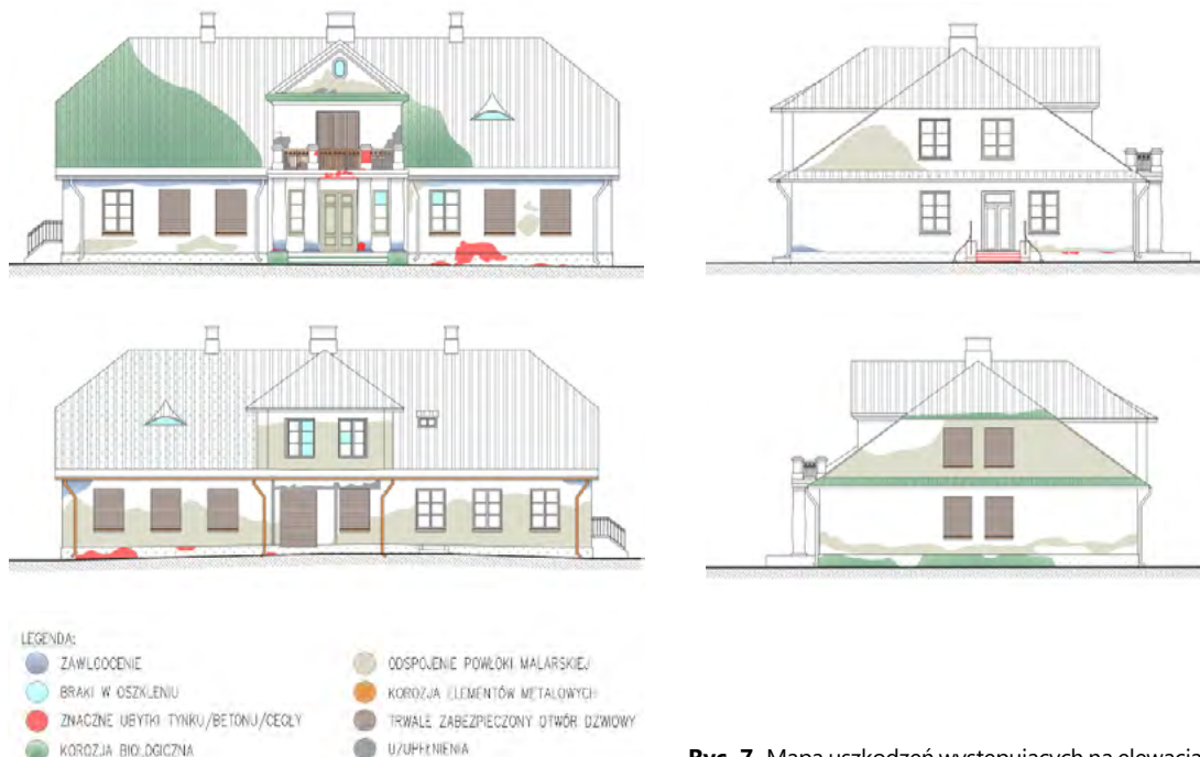
Ryc. 7. Mapa uszkodzeń występujących na elewacjach.
