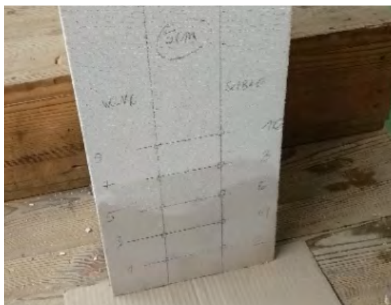
Ryc. 7. Siatka punktów na bloczku z autoklawizowanego betonu komórkowego
