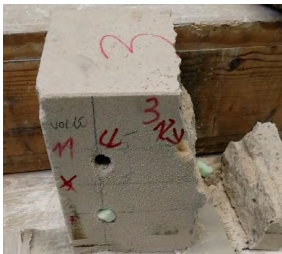
Ryc. 6. Bloczek silikatowy po pobraniu zwierziny
