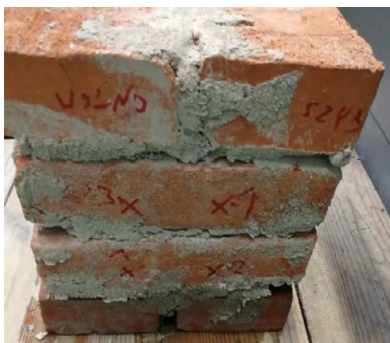
Ryc. 10. Oznaczenie punktów poboru zwierziny na murku
