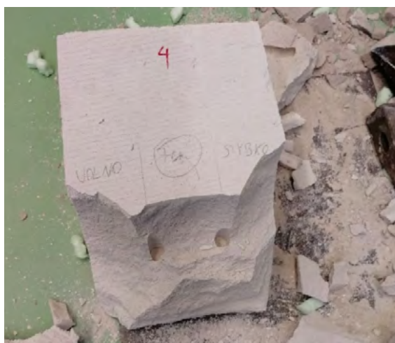
Ryc. 9. Bloczek betonu komórkowego po odkuciu próbek
