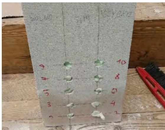
Ryc. 8. Bloczek z autoklawizowanego betonu komórkowego z uzupełnionymi otworami po wierceniu
