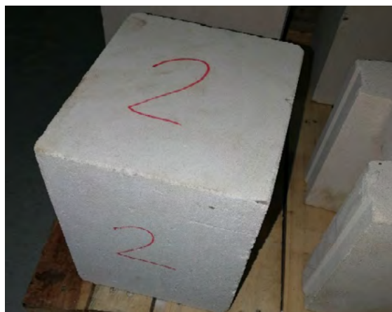
Ryc. 2. Błoczek silikatowy Silka E-A, zawierający kruszywo bazaltowe
