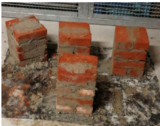
Ryc. 1. Słupki z cegły ceramicznej pełnej na zaprawie cementowo-wapiennej
