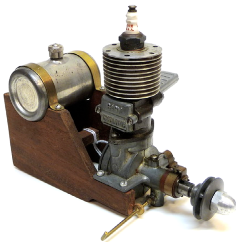
Rys. 5. Baby Cyclone C, typowy silniczek spalinowy do napędu modeli latających w latach 30. XX w. [12]
