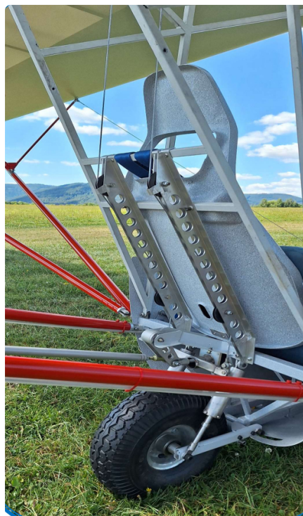
Ryc. 7. Szczegóły podwozia oraz przeniesienia napędu lotek
