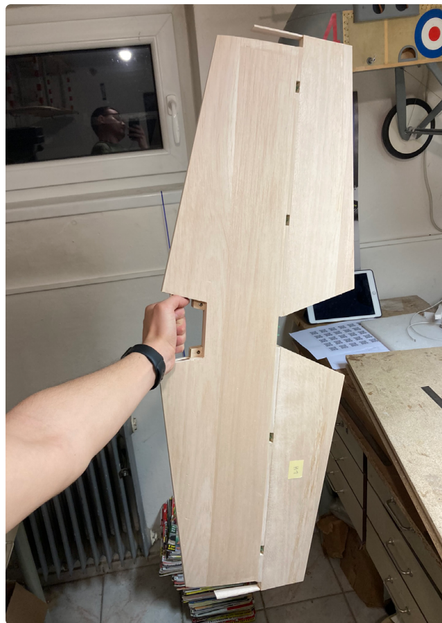
Ryc. 8. Kompletne usterzenie poziome przed wykończeniem
