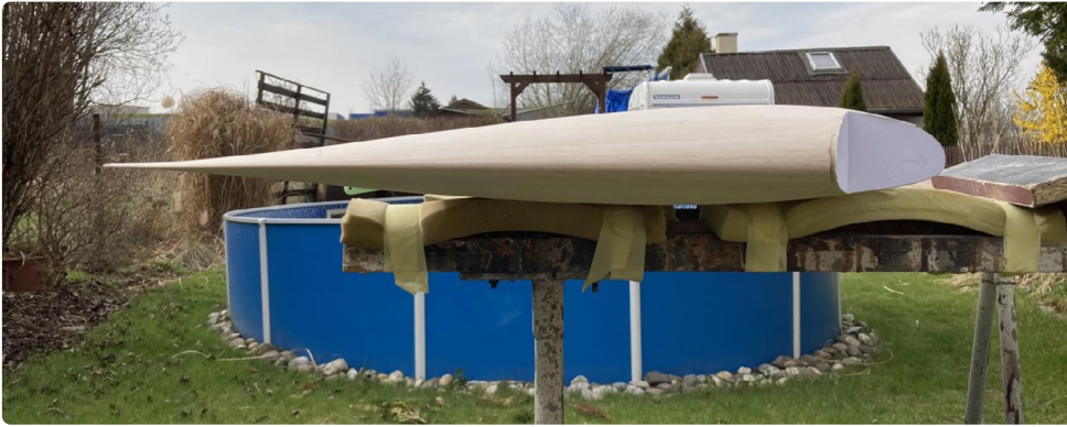
Ryc. 5. Łuk końcowy skrzydła jest laminowany paskami balsy, a następnie szlifowany do odpowiedniego kształtu
