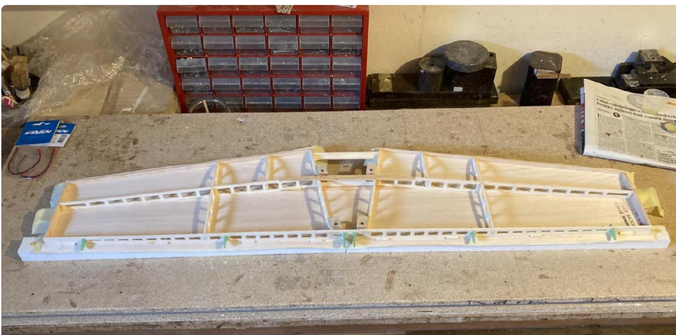
Ryc. 7. Konstrukcja wewnętrzna statecznika poziomego jak w oryginale
