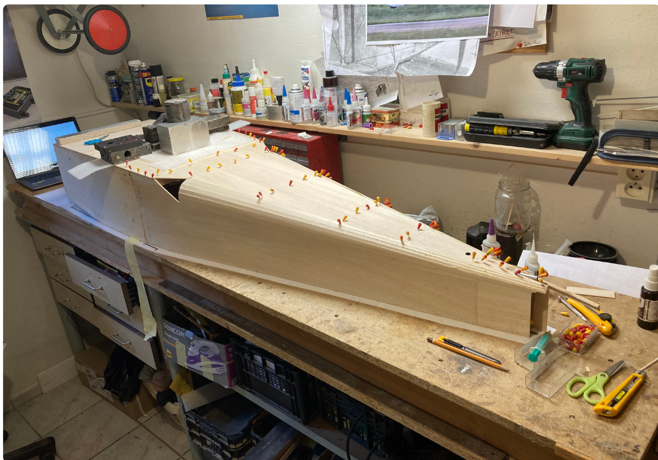
Ryc. 13. Klejenie poszycia kadłuba
