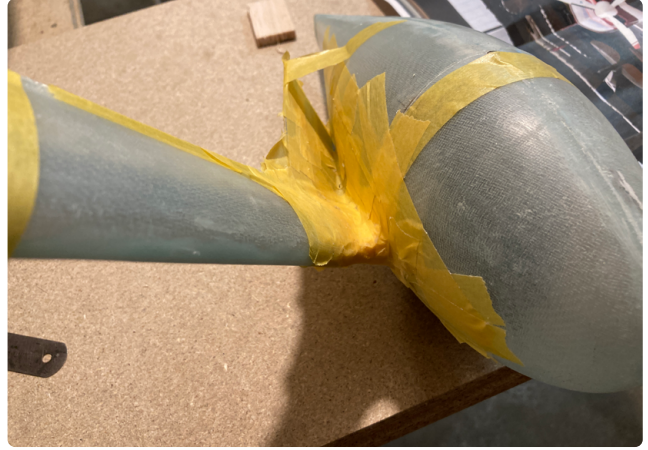
Ryc. 23. Wykonanie oprofilowania przejścia między rękawem goleni podwozia a osłoną koła
