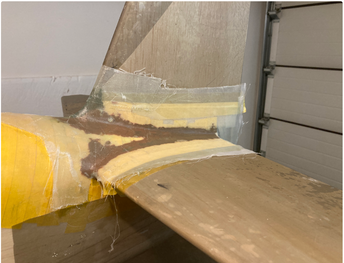
Ryc. 19. Wykonanie opprofilowania przejścia między sterem wysokości i kierunku
