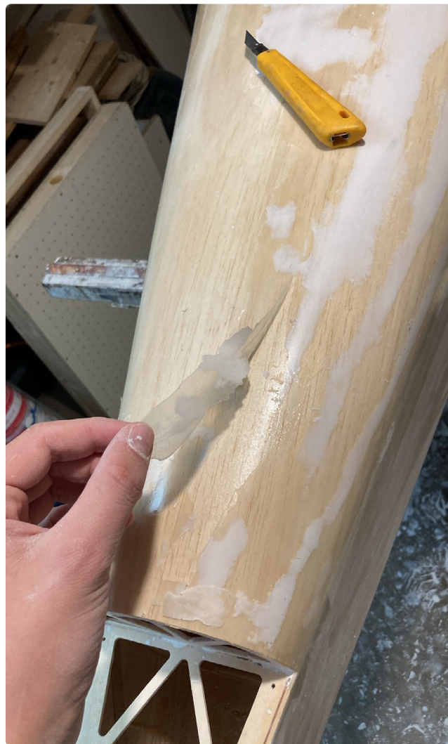
Ryc. 16. Laminowanie kadłuba tkaniną szklaną przesyconą żywicą epoksydową
