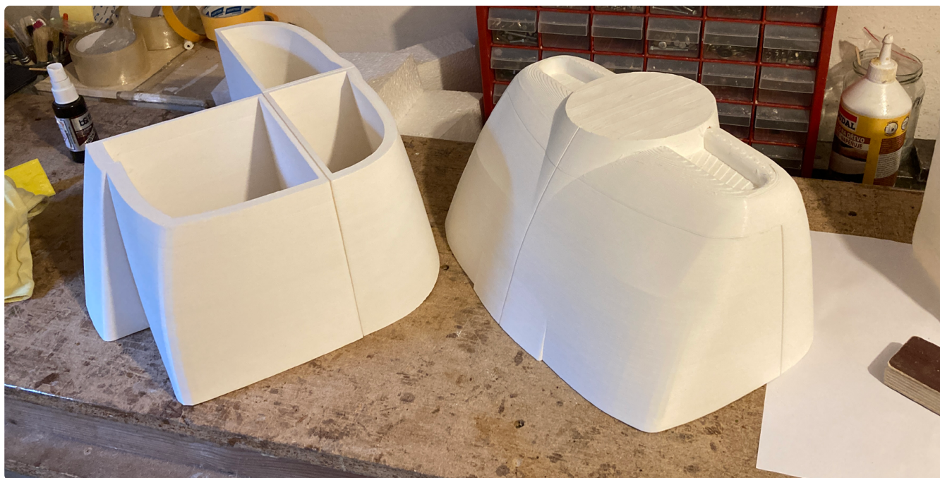
Ryc. 17. Budowa formy pozytywowej osłony silnika
