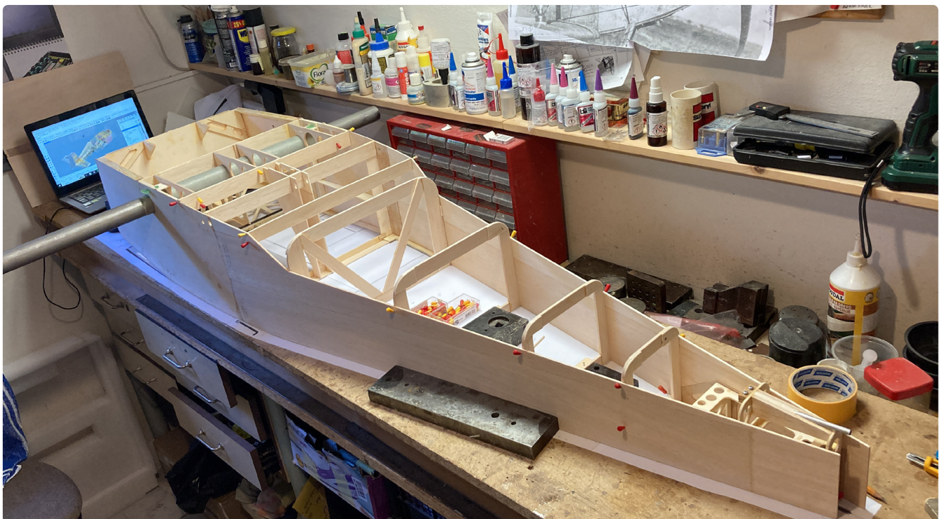
Ryc. 11. Kadłub w trakcie montażu
