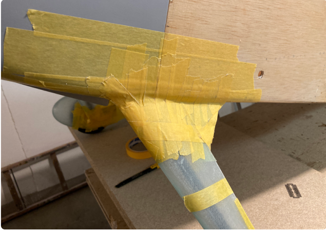
Ryc. 22. Wykonanie oprofilowania przejścia między rękawem goleni podwozia a kadłubem
