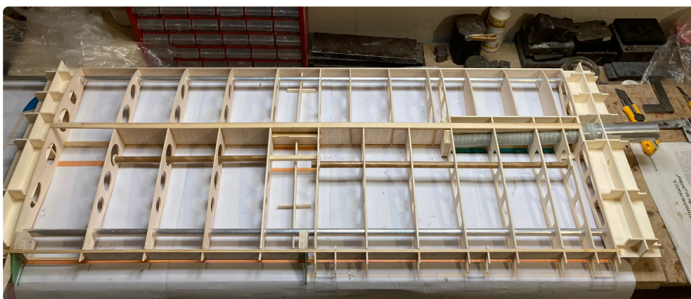
Ryc. 4. Skrzydła zbudowane są na dwóch rurach prowadzących. Już na etapie budowy przygotowałem w skrzydle papierowe rurki do przeciągnięcia kabli
