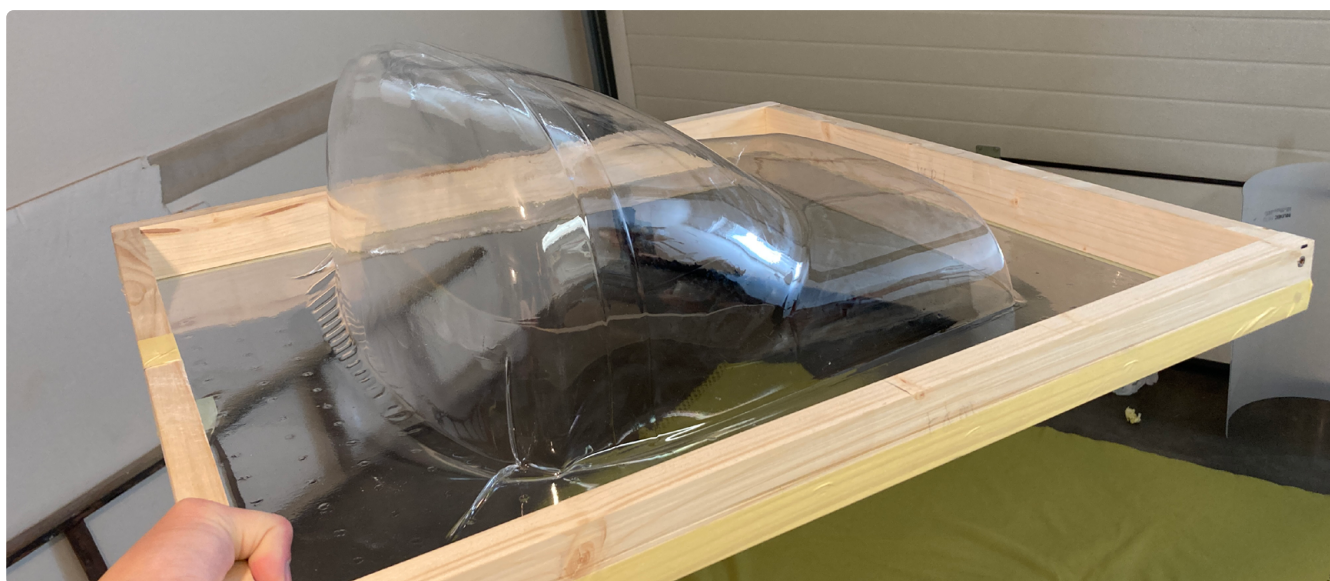
Ryc. 27. Surowa wypraska przedniej części ostony kabiny
