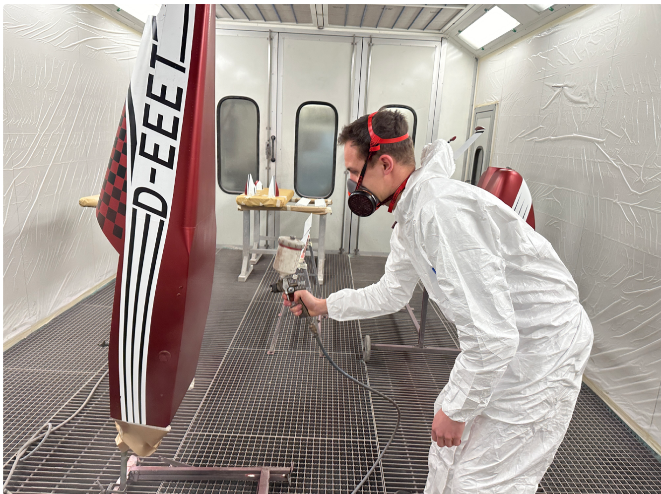
Ryc. 35. Malowanie natryskowe modelu w komorze lakierniczej
