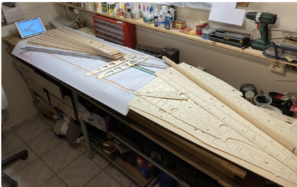
Ryc. 3. Wyfrezowane części gotowe do budowy skrzydeł
