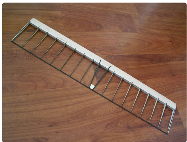
Ryc. 11. Szkielet statecznika poziomego modelu klasy F1B
