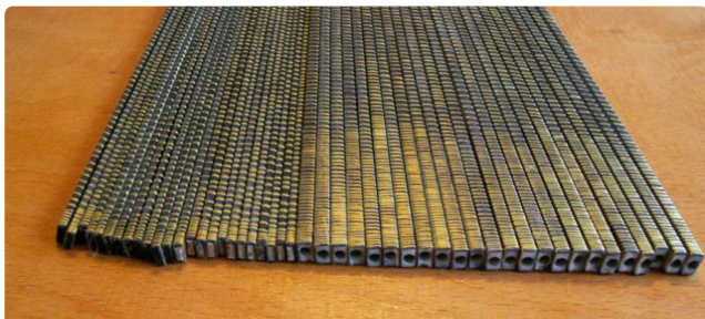
Ryc. 5. Dźwigary skrzydeł modelu F1B
