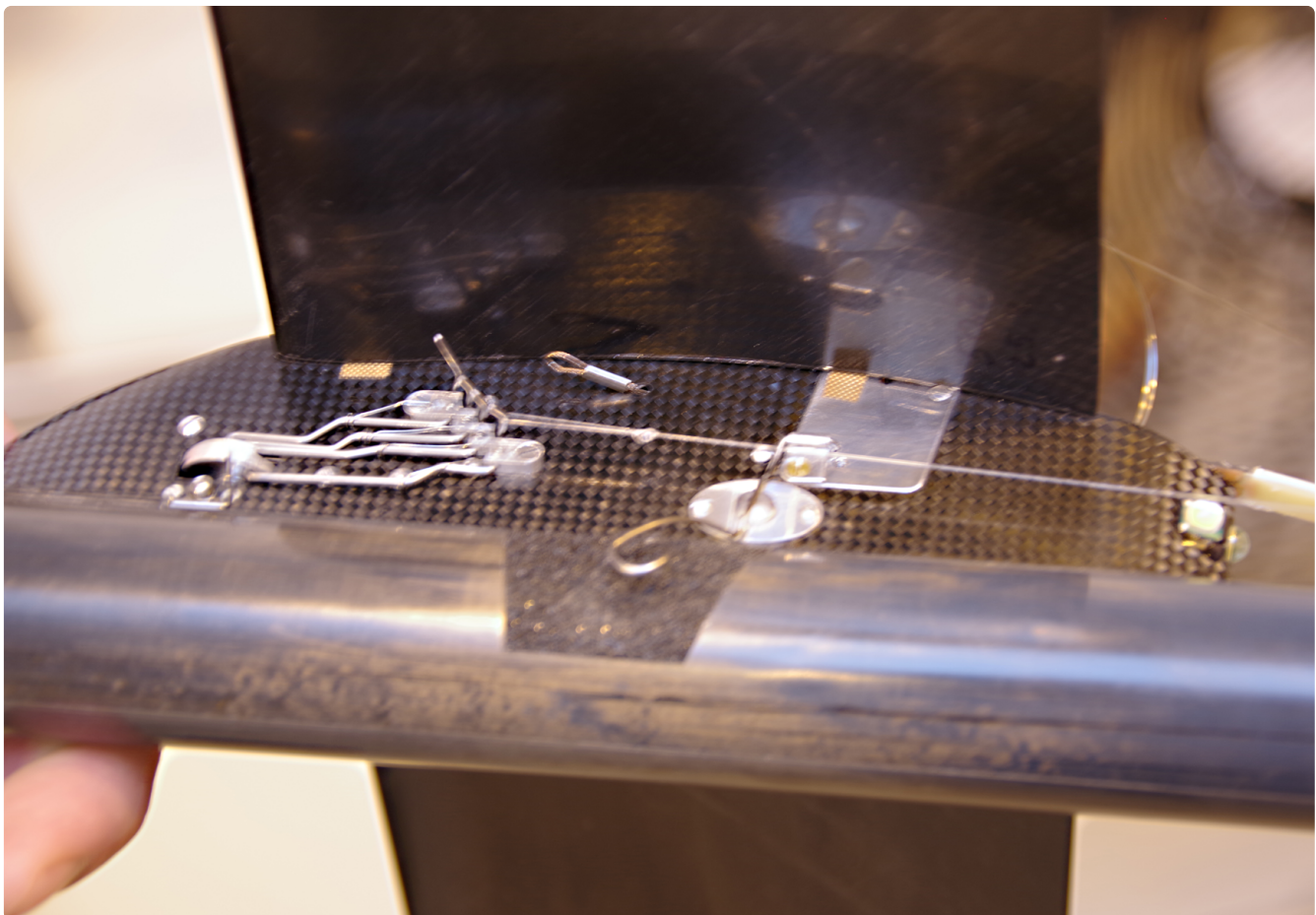
Ryc. 3. Wieżyczka, na której montowane są bagnety - łączniki płatów, a ponadto wewnątrz ulokowana jest elektronika sterująca pracą śmigła, steru kierunku oraz determalizatora
