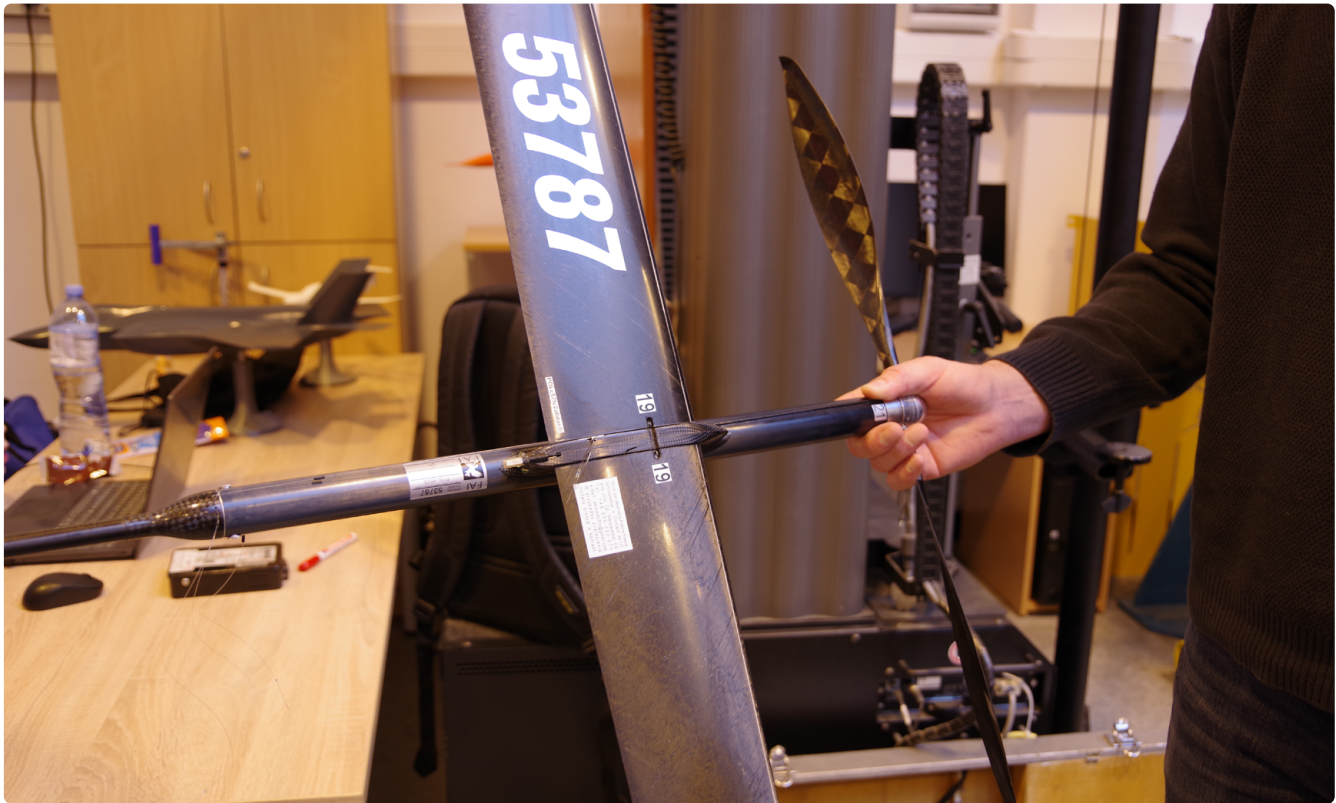
Ryc. 2. Środkowa część kadłuba wykonana w formie rury (mieści silnik gumowy)
