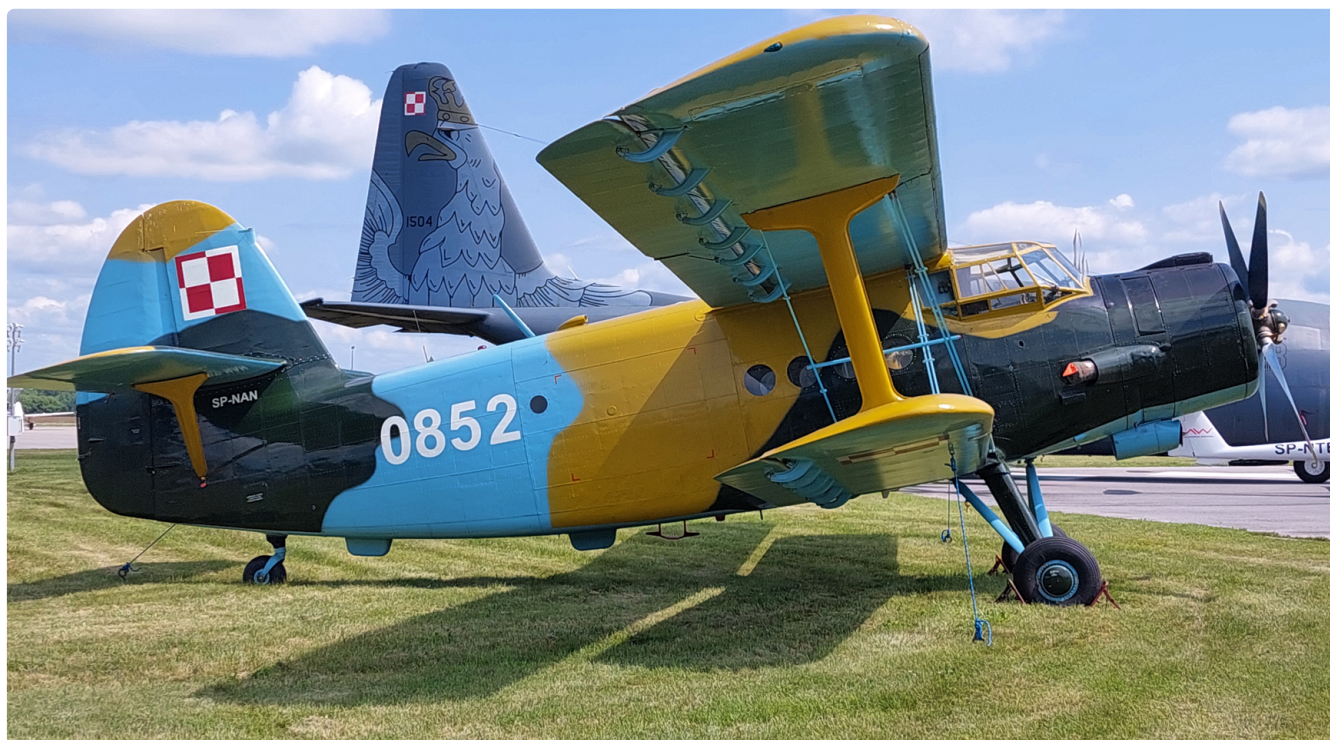
Ryc. 3. AN2 z silnikiem gwiazdowym – konstrukcja z lat 30. XX w., służył głównie do obsługi skoków spadochronowych. Fot. Jarosław Mądro
