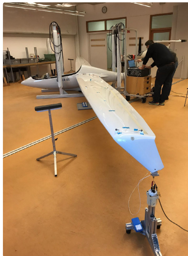
Ryc. 12. Punkty na strukturze płatowca oznaczone markerami do skanowania 3D
