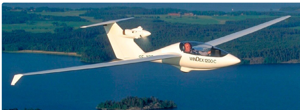
Ryc. 1. Motoszybowiec Windex 1200 z napędem na silnik spalinowy
