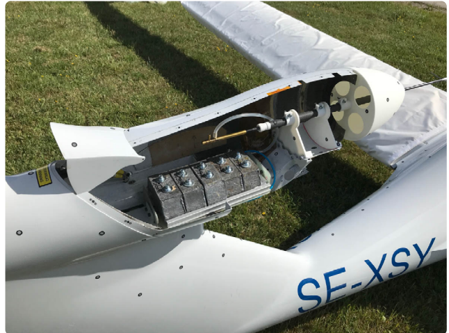
Ryc. 3. Balast w miejscu wbudowanego silnika spalinowego
