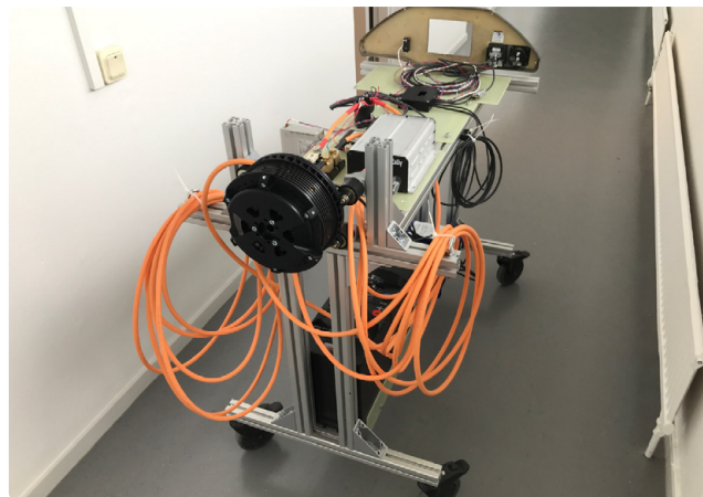
Ryc. 7. System napędowy FES przed montażem
