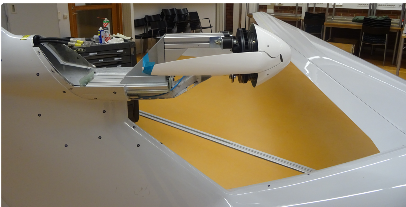
Ryc. 8. Elektryczny system napędowy FES zabudowany w gondoli
