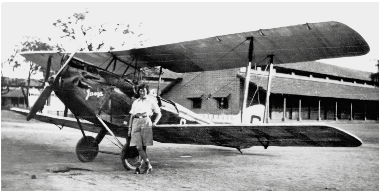
Ryc. 1. Amy Johnson przy samolocie DH 60 Moth o konstrukcji całkowicie drewnianej
