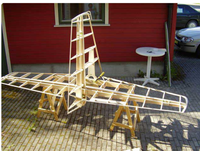
Ryc. 10. Konstrukcja części ogonowej – usterzenia poziome i pionowe
