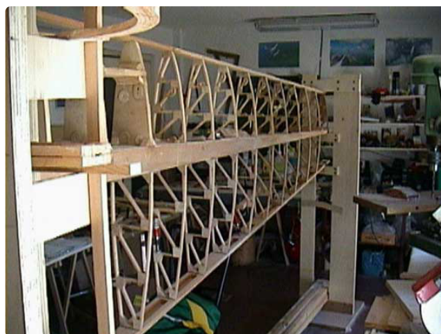
Ryc. 8. Drewniana konstrukcja kadłuba samolotu F8L Falco. Widoczne laminowane wręgi
