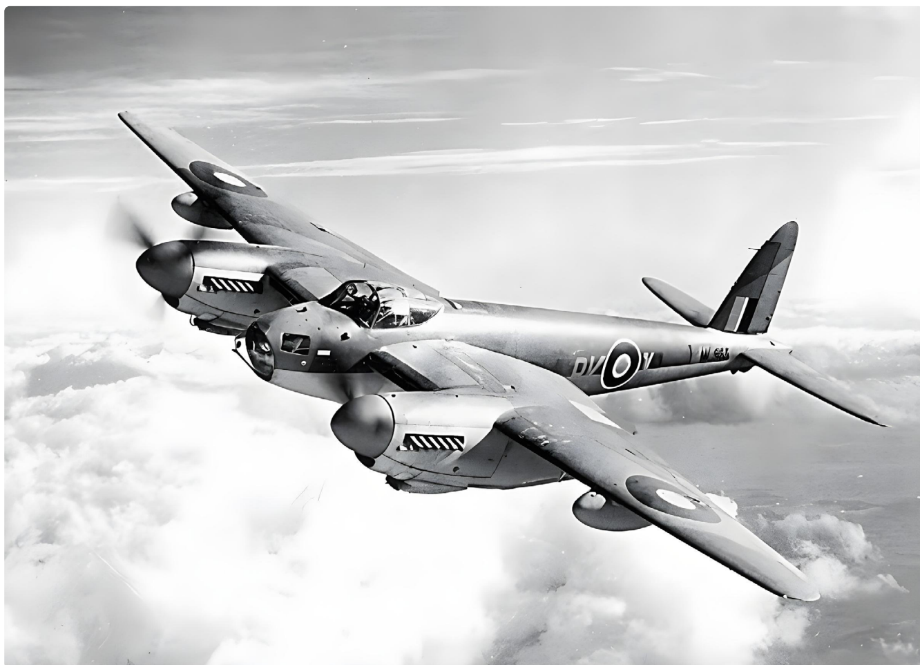
Ryc. 3. DH 98 Mosquito, dwusilnikowy samolot rozpoznawczo-myśliwsko-bombowy o konstrukcji drewnianej
