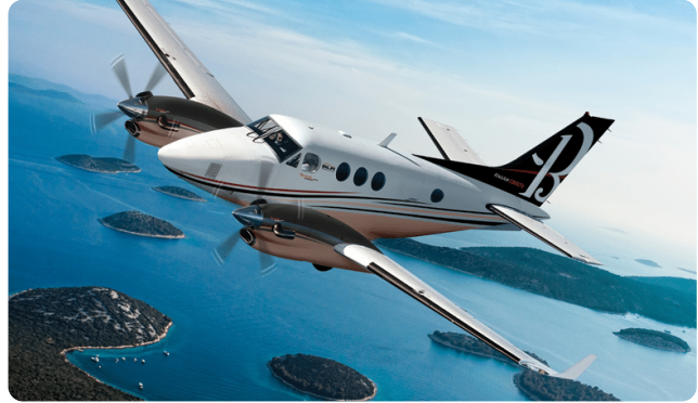
Ryc. 14. Samolot Beech King Air 90 ze śmigłami pięciołopatkowymi MT
