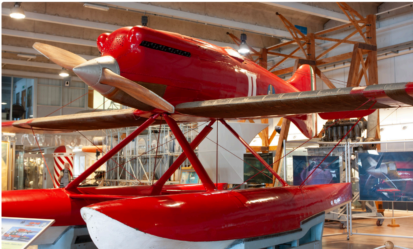
Ryc. 5. Wodnosamolot Macchi M.39 w widoku z przodu. Śmigło drewniane, dwułopatowe. Widoczna chłodnica oleju poniżej kołpaka śmigła sięgająca aż do krawędzi natarcia skrzydła. Chłodnica cieczy w postaci rurek mosiężnych na dolnej i górnej powierzchni płatów
