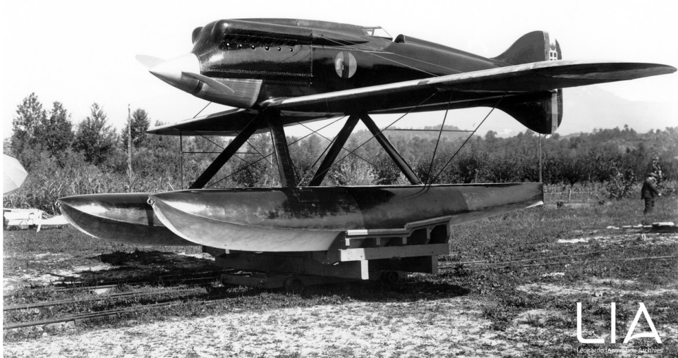
Ryc. 7. Wodnosamolot Macchi M.52. Bardzo dobrze widoczna chłodnica oleju. Na przodzie kadłuba namalowany symbol topora przywiązanej wstążkami do wiązki różg oraz herb dynastii sabaudzkiej na sterze kierunku. Zwraca również uwagę metalowe śmigło po raz pierwszy zastosowane w konstrukcji Macchi
