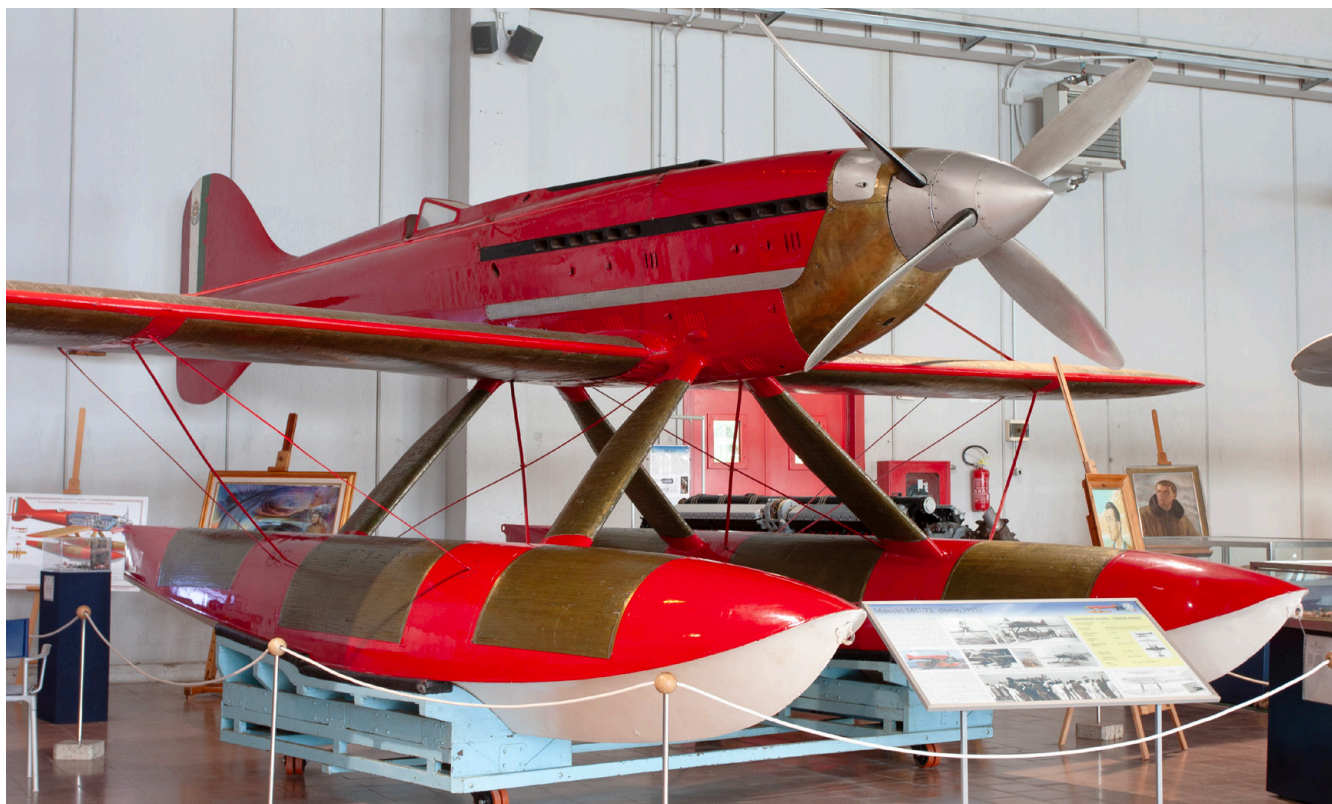
Ryc. 13. Wodnosamolot Macchi M.C.72. Bardzo dobrze widoczne dwa niezależne śmigła, powiększona chłodnica oleju bezpośrednio za kołpakiem oraz rząd 12 rur wydechowych. Zwraca uwagę także rozbudowany układ chłodnic na wspornikach płwaków i na samych płwakach
