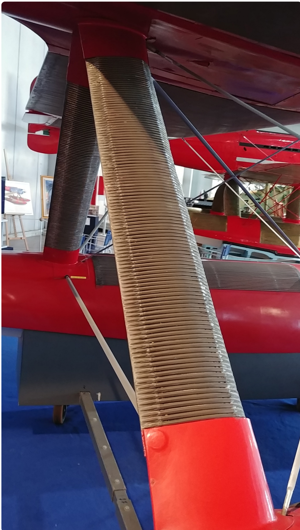
Ryc. 14. Zbliżenie na wspornik pływaka modelu M.C.72 – dobrze widoczne poszczególne rurki systemu chłodzenia. Zwraca uwagę również aerodynamiczny profil samego wspornika
