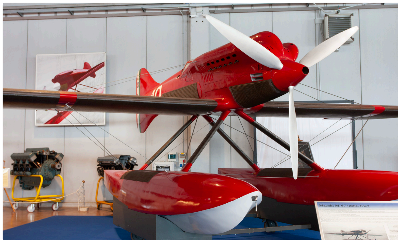
Ryc. 9. Wodnosamolot Macchi M.67. Dobrze widoczny system chłodzenia cieczy w postaci sekwencji rurek mosiężnych na powierzchniach płata oraz na bocznych powierzchniach kadłuba w obrębie kabiny pilota. W tym egzemplarzu chłodnice zamontowano również na wspornikach pływaków oraz na samych pływakach. Widoczne charakterystyczne osłony silnika chroniące trzy rzędy cylindrów
