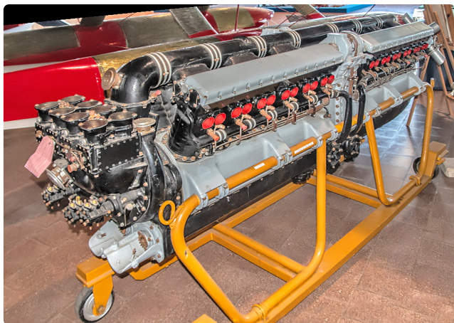
Ryc. 12. Silnik Fiat AS.6. – modułowa konstrukcja składająca się z dwu silników AS.5. Doskonale widoczny rząd kanałów dolotowych i wylotowych z poszczególnych cylindrów
