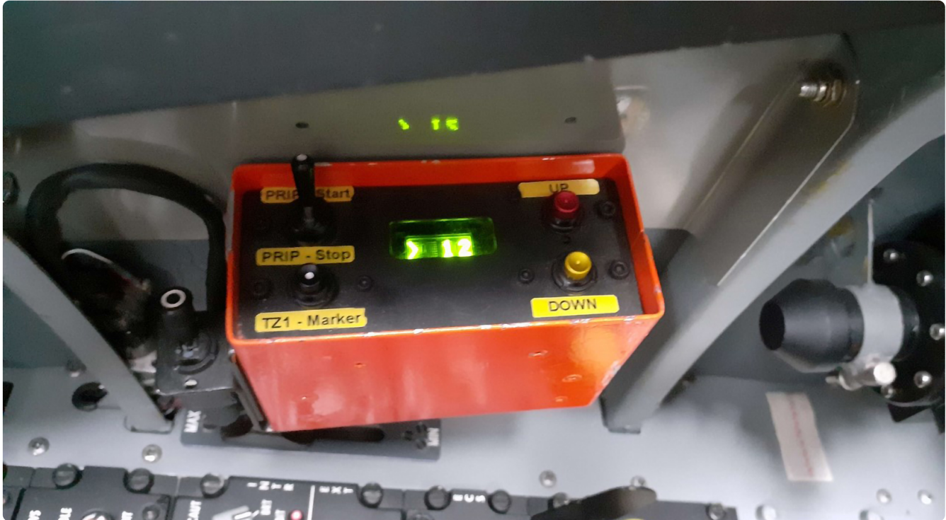
Ryc. 8. Manipulator oznaczania punktów testowych w kabinie samolotu Aero L-39 Skyfox
