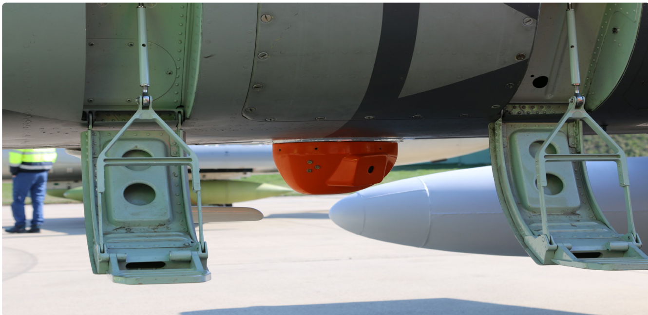
Ryc. 6. Kamera zainstalowana pod kadłubem samolotu
