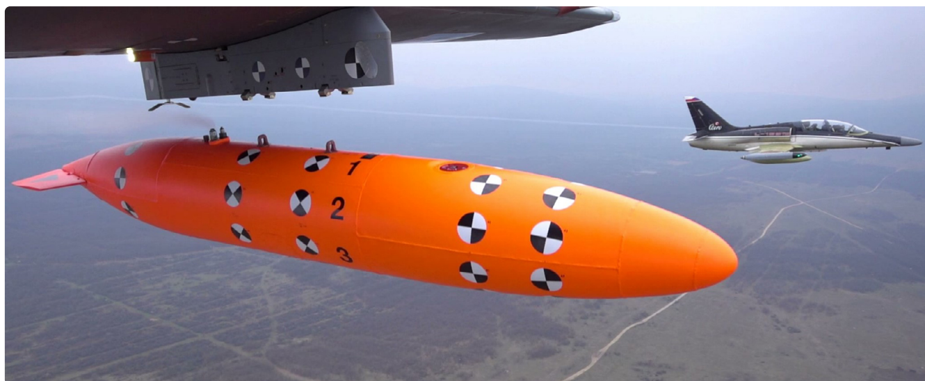
Ryc. 5. Próba separacji opróżnionego zbiornika paliwa w locie
