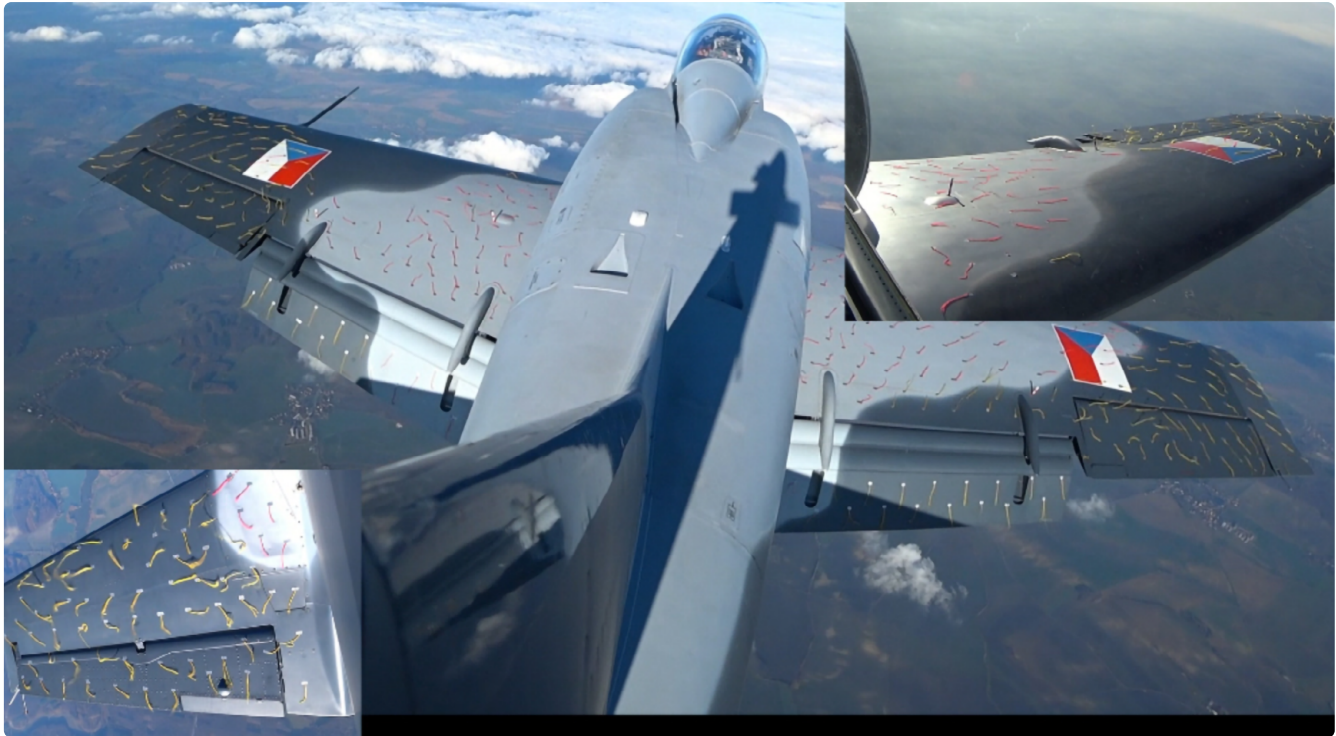
Ryc. 1. Zaburzenia przepływu na powierzchniach aerodynamicznych samolotu Aero L-39 Skyfox powstałe wskutek przeniesienia zbiorników paliwa na końcówki skrzydeł. Wizualizacja przy użyciu nitek bawełnianych
