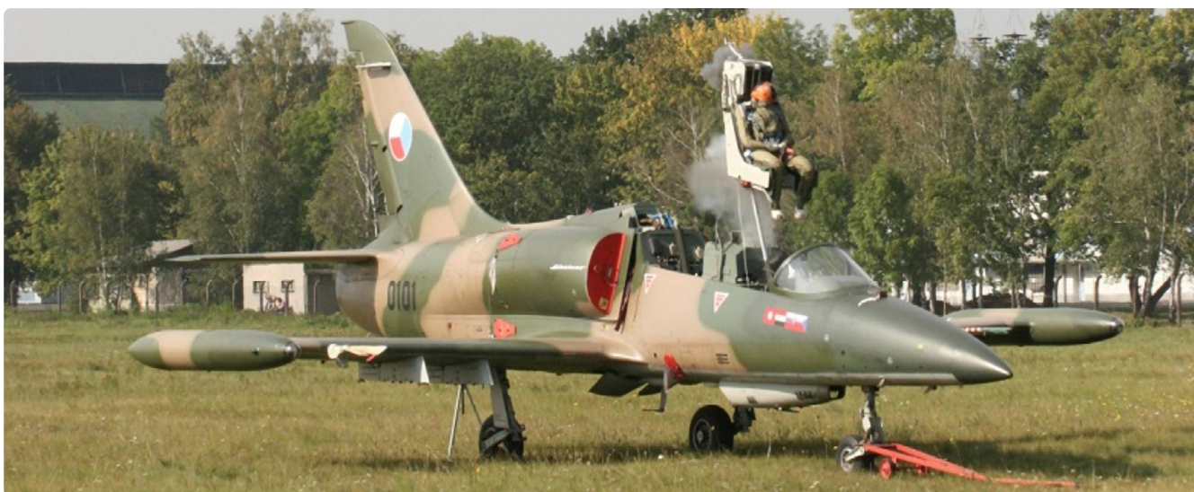
Ryc. 3. Próba naziemna fotela katapultowanego VS-20 w samolocie Aero L-159
