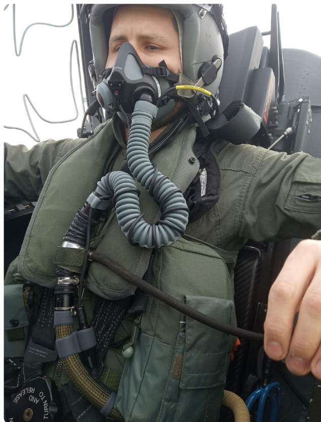
Ryc. 4. System podtrzymywania życia w samolocie Aero L-39 Skyfox podczas testów z udziałem pilota doświadczalnego
