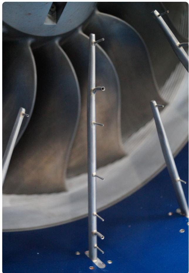
Ryc. 2. Oprzyrządowanie do pomiaru pola ciśnienia w sprzężarce silnika podczas prób w locie
