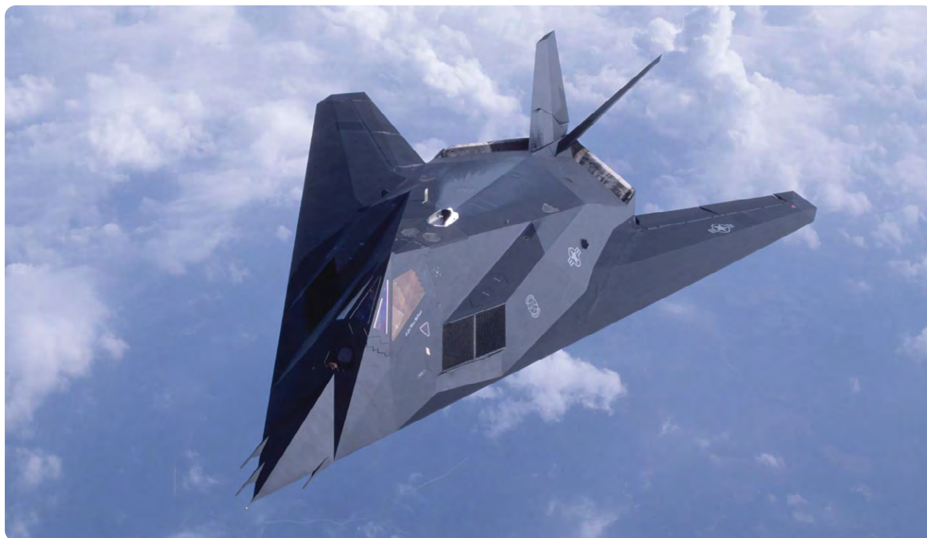
Ryc. 2. Samolot F-117 Nighthawk wyróżniający się płaskimi, pochylonymi powierzchniami służącymi odbijaniu fal radarowych (źródło: Peter R. Foster, https://www.key.aero/article/going-war-f-117-pilots-perspective )
