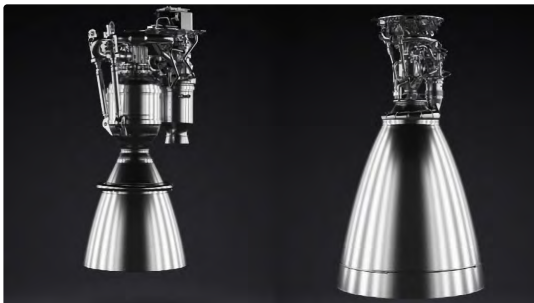
Ryc. 5. Silnik Merlin 1D oraz Merlin Vacuum z wyraźnie większą dyszą [4]
