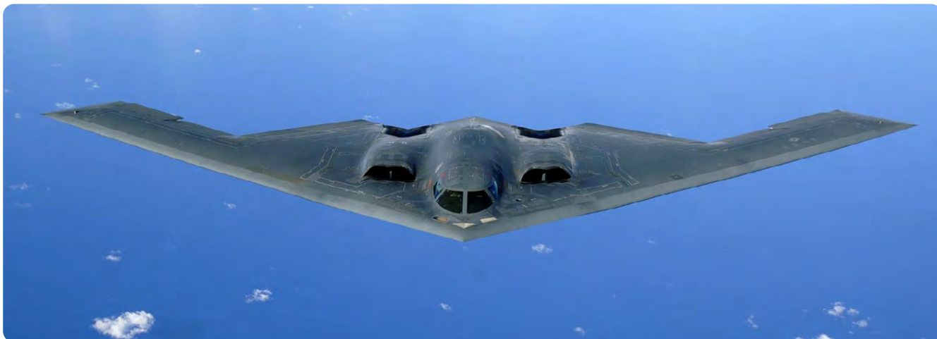
Ryc. 3. Northrop B-2 Spirit. Pozbawienie samolotu statecznika pionowego pozwoliło znacznie ograniczyć echo radarowe (źródło: https://www.defenseindustrydaily.com/usas-b2-bombers-leading-the-way-in-contracting-for-availability-02950/ )
