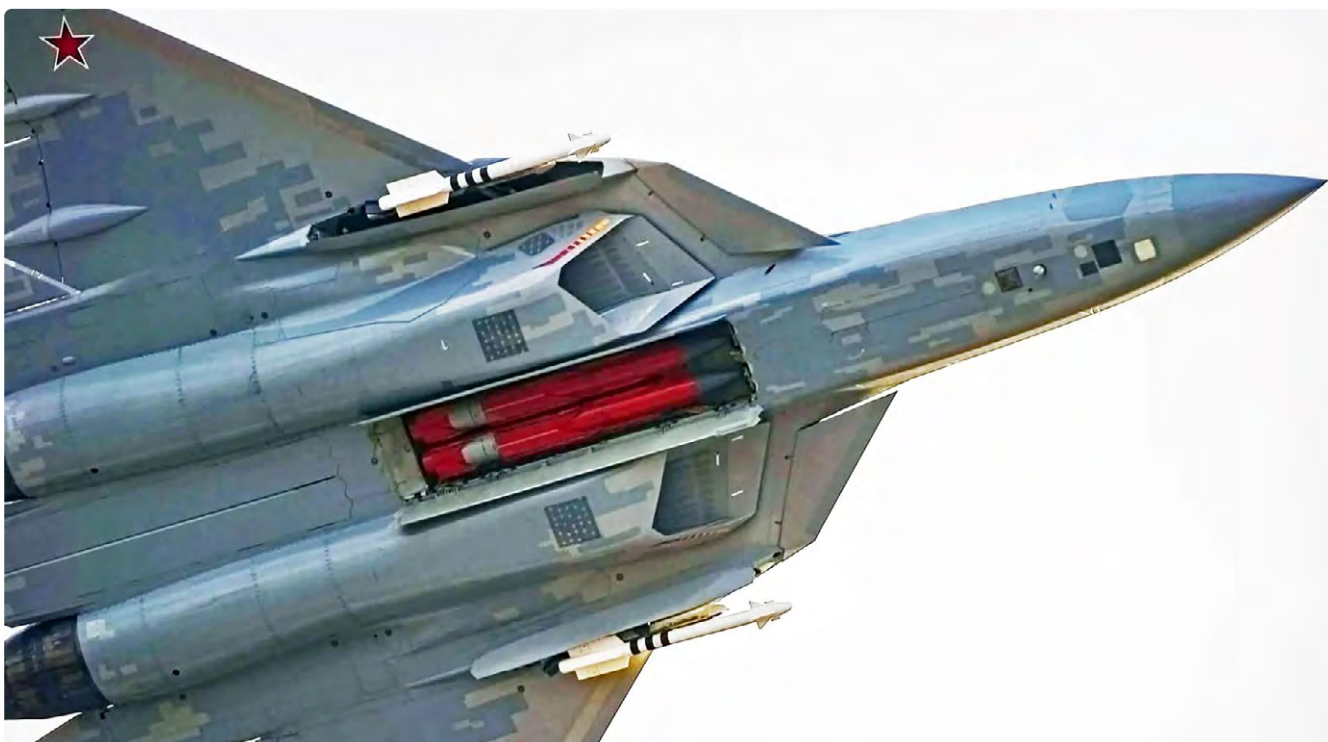
Ryc. 4. Spód samolotu Su-57. Widoczne wewnętrzne komory uzbrojenia w pozycji otwartej (źródło: https://www.twz.com/air/su-57-felon-brandishes-its-loaded-weapons-bays-for-the-first-time )
