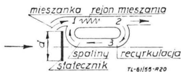
Rys. 20. Model stabilizacji płomienia przez recyrkulację
