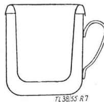
Rys. 7. Schemat naczynia chłodzonego wodą dla przetrzymywania przygotowanej substancji klejącej
