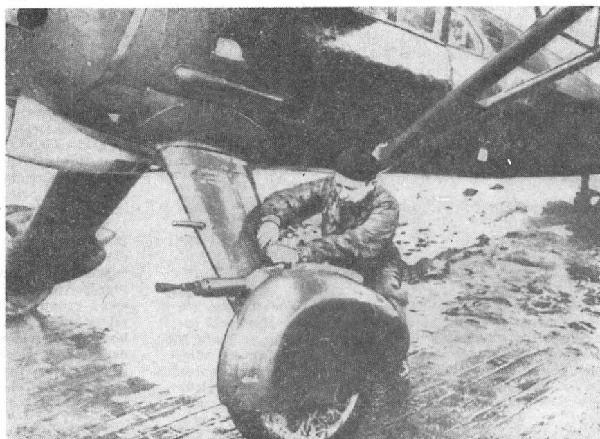
Uzbrojenie mocowane na podwoziu pierwszego prototypu Mewy
