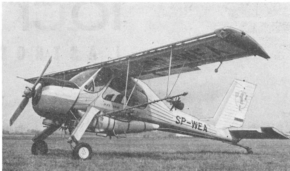
Prototyp wersji rolniczej samolotu PZL-104 Wilga 35 z 300-litrowym zbiornikiem i otomizerami — oblatany 10.II.1978 r.
