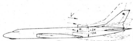
Rys. 9. Wpływ odkształcalności konstrukcji samolotu na wielkość wychylenia steru
