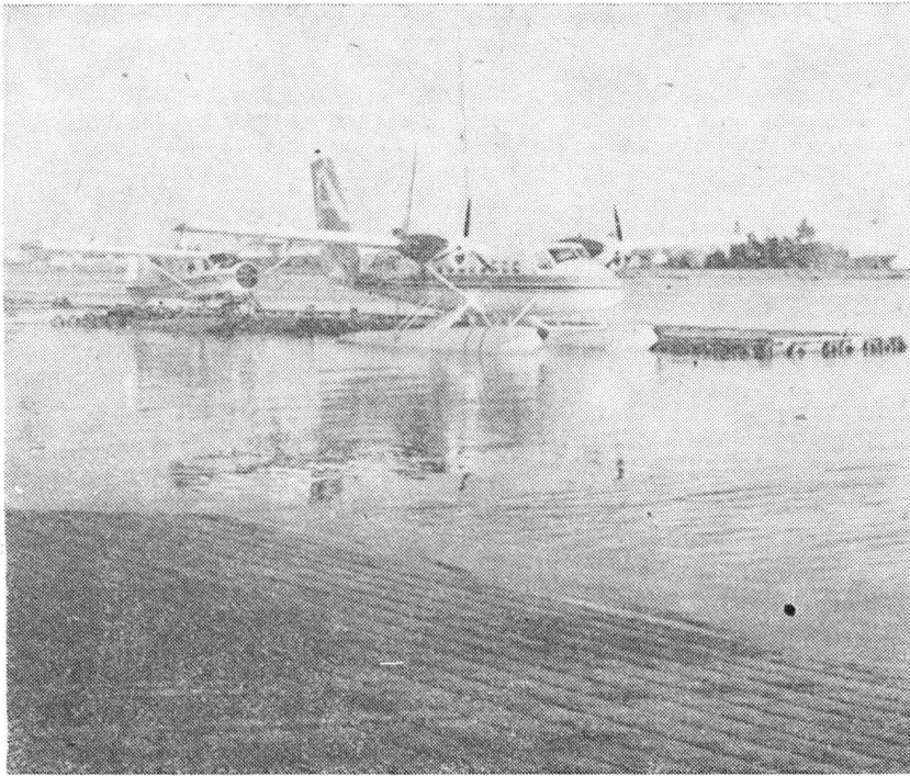
Rys. 7. Ogólny widok pomostu z przycumowanymi samolotami (Beaver i Twin Otter). Widoczne odbijacze ze starych opon. Na pierwszym planie pochylnia (slip)
