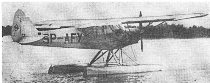
Rys. 22. Piper Cub na pływakiach konstrukcji prof. J. Teisseyre. Rys. 18÷22 ze zbiorów A. Glassa
