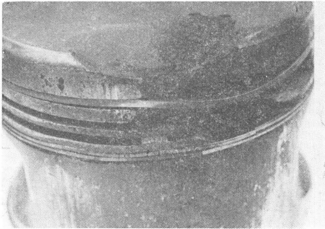
Rys. 12. Skutki pracy silnika ASz-82T z wykruszonym kołnierzem tłoka (widoczny otwór w tłoku)
