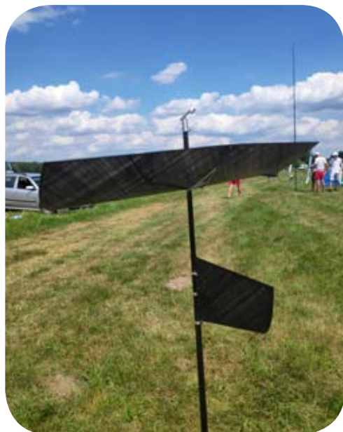
Rys. 2. Usterzenie modelu F1B Adama Krawca. Zwraca uwagę wychylony statecznik poziomy
