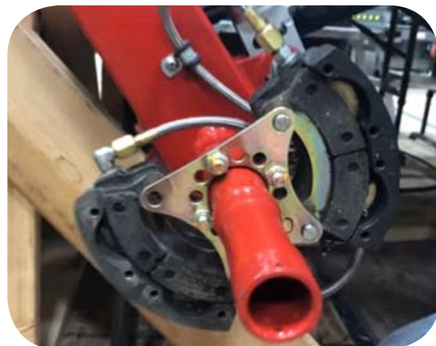
Rys. 8. Oś koła podwozia głównego oraz tarcze hamulcowe. Fot. Mike Patey
