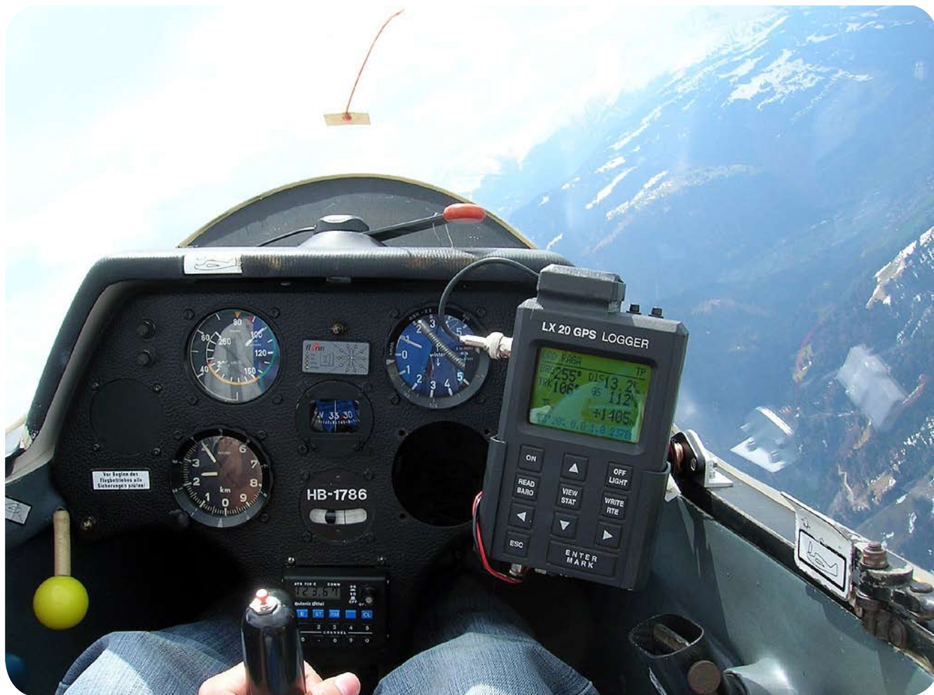
Rys. 3. LX 20 Logger jako wyposażenie szybowca ASK 23, podczas lotu nad Alpami (dzięki uprzejmości Martin Zahner)
