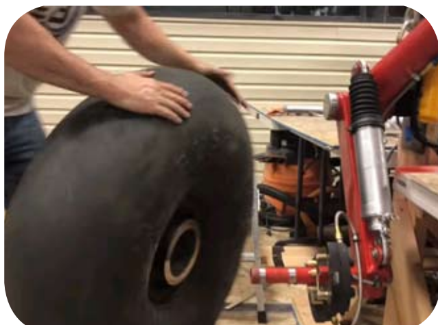
Rys. 7. Podwozie główne samolotu Wilga DRACO. Fot. Mike Patey
