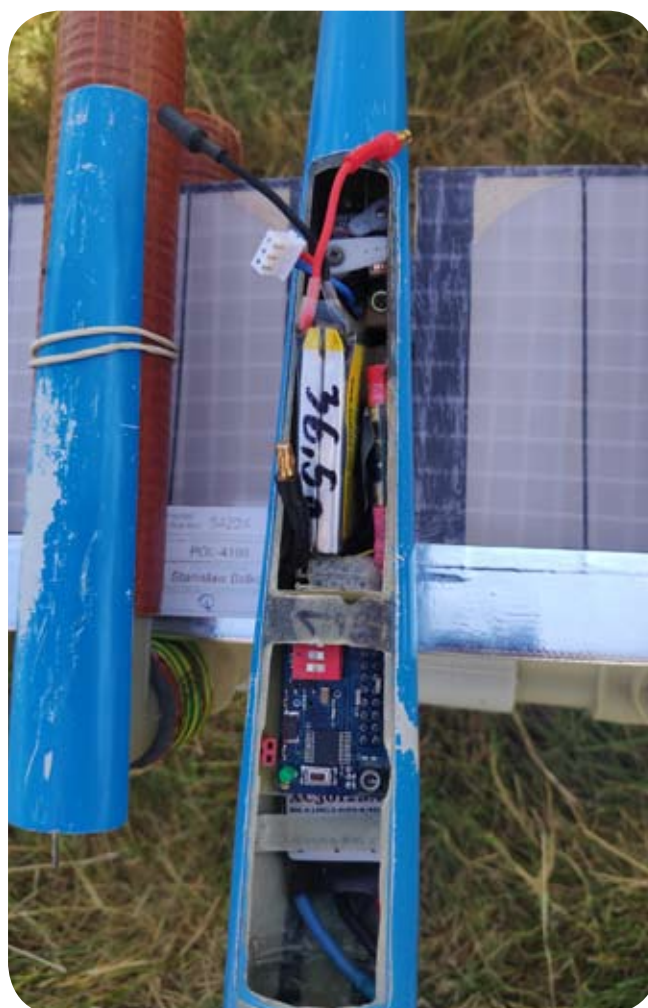
Rys. 13. Wnętrze kadłuba modelu klasy F1Q. Widoczny akumulator zasilający oraz elektroniczny wyłącznik silnika napędowego
