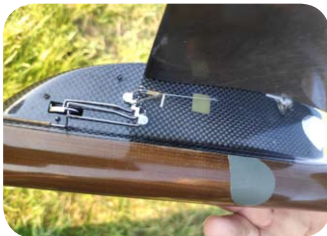
Rys. 9. Wieżyczka modelu klasy F1B S. Skibickiego. Widoczne dźwignie mechanizmu zegarowego
