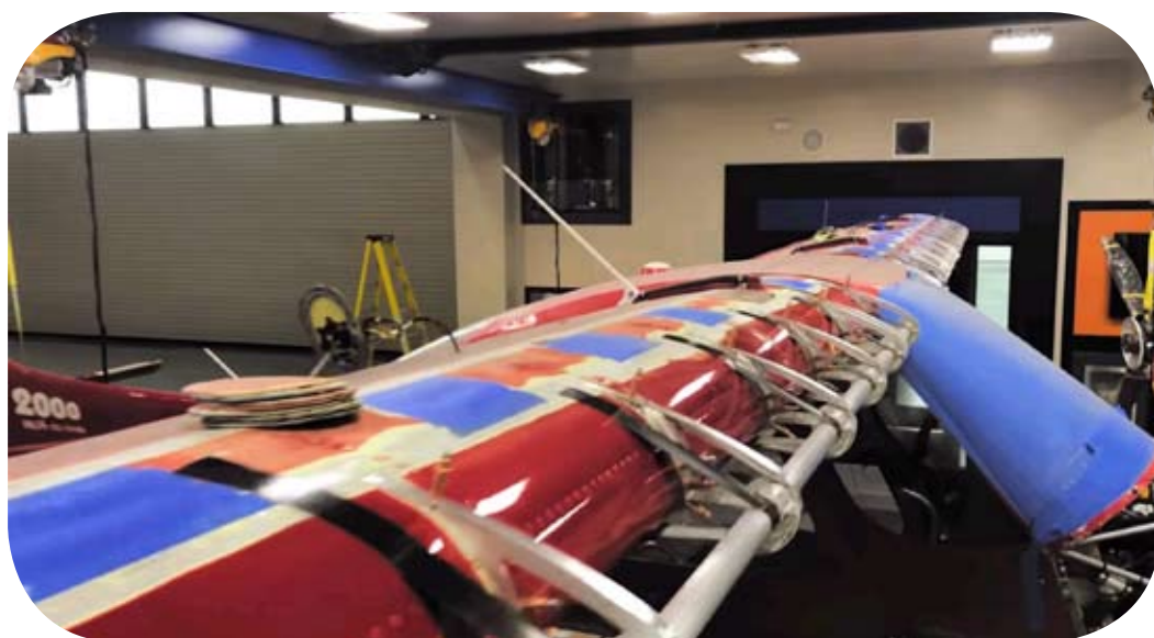
Rys. 4. Konstrukcja noska poszerzającego cięciwę skrzydła. Fot. Mike Patey
