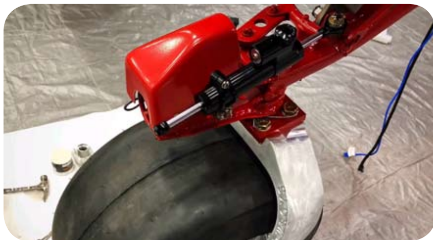
Rys. 9. Koło ogonowe zawieszane na mechanizmie umożliwiającym obrót o 360°. Fot. Mike Patey
