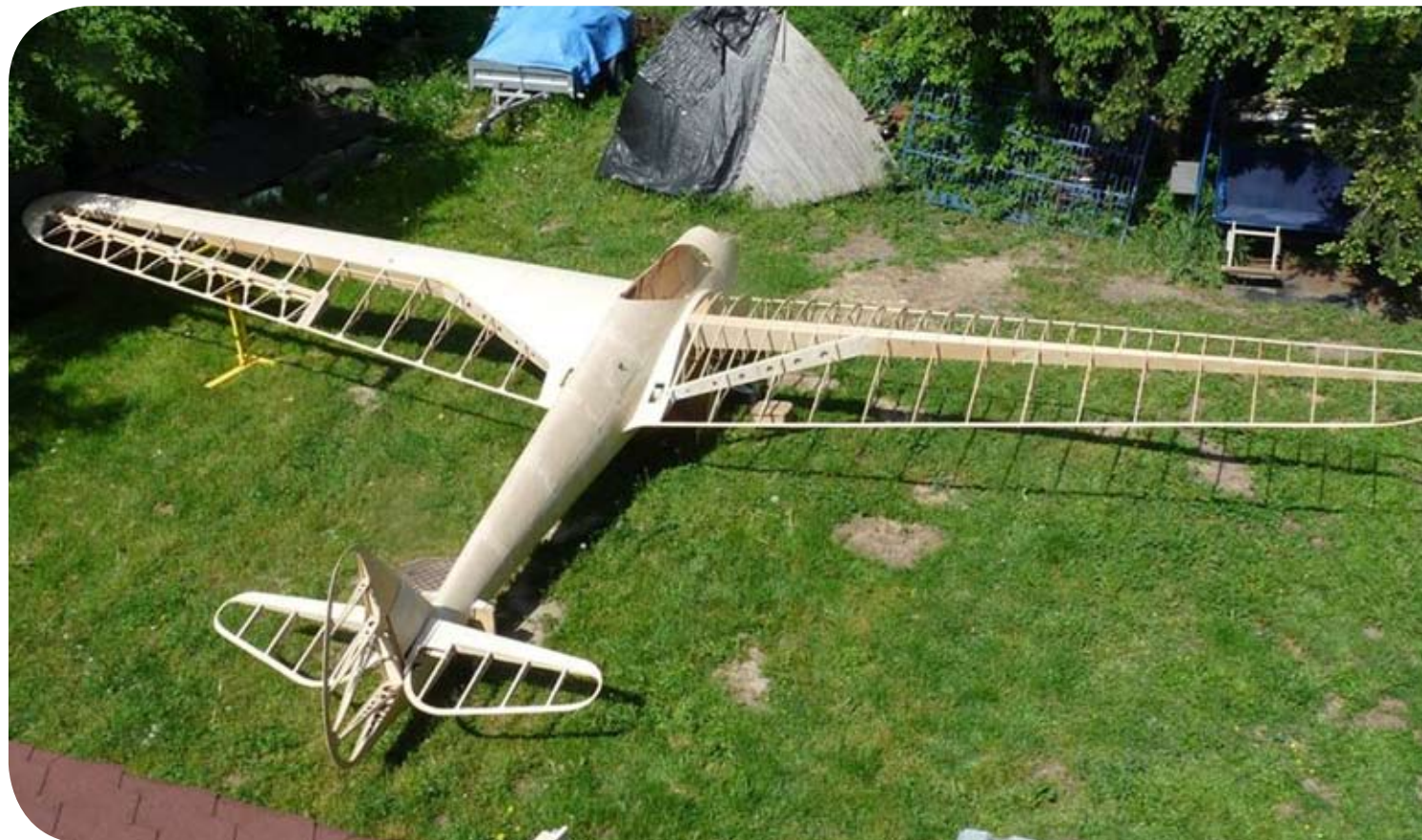
Rys. 2. Replika przedwojennego motoszybowca Bąk II Antoniego Kocjana, zbudowana przez Jerzego Gruchalskiego w 2016 r. na zamówienie Fundacji Zabytki Polskiego Nieba. Konstrukcja drewniana, kryta sklejką i płótnem. Bąk wciąż niestety czeka na oblot. Fot. Jerzy Gruchalski
