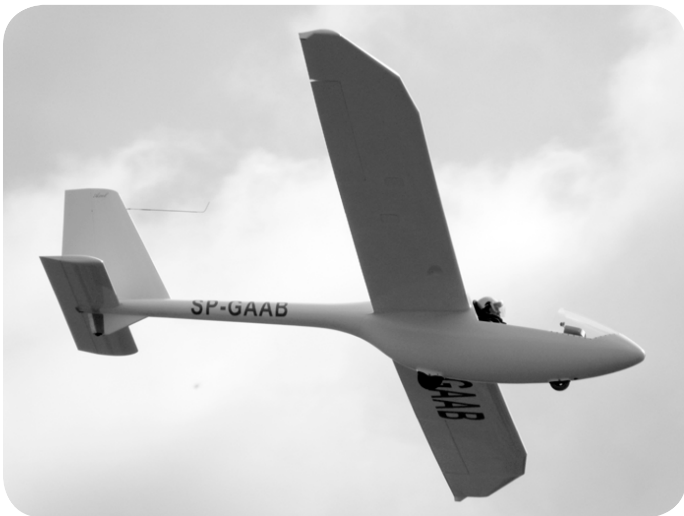
Rys. 6. Ultralekki szybowiec Axel w locie. Konstrukcja z kompozytu węglowego. Być może w 2022 r. ruszy jego produkcja seryjna w Mielcu. Fot. Dariusz Lewek
