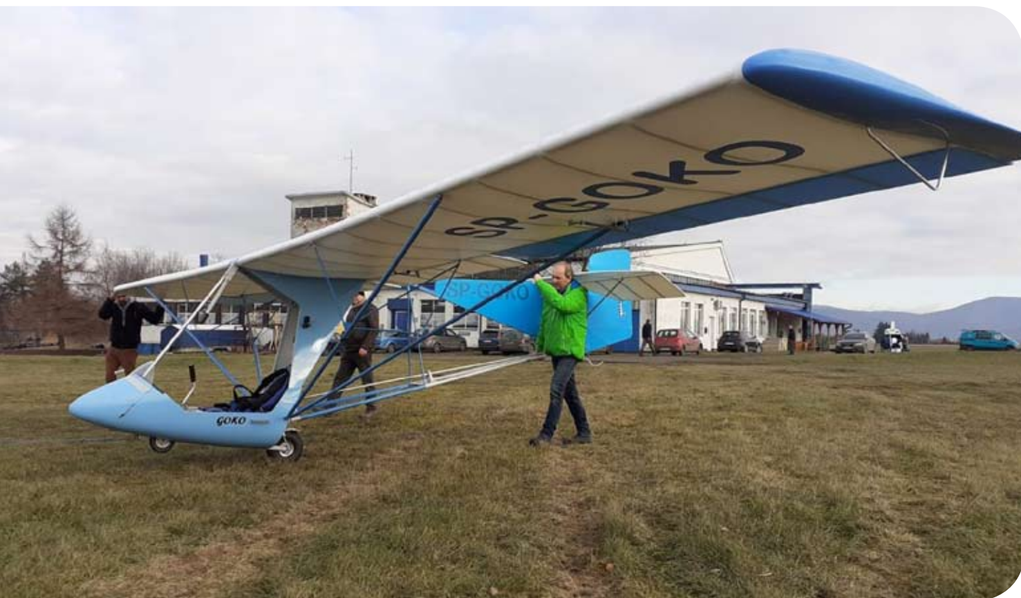
Rys. 3. Szybowiec Goko z 2021 r. – konstrukcja amatorska czy profesjonalna? Ultralekki szybowiec zaprojektowany i zbudowany w Bielsku przez zawodowych konstruktorów lotniczych, wzorowany na szybowcu Goat. Rozwojowa wersja jako motoszybowiec z silnikiem elektrycznym będzie mieściła się w klasie K5, podkategoria UL-115. Konstrukcja metalowa, kryta sztucznym płótnem. Fot. Michał Ombach
