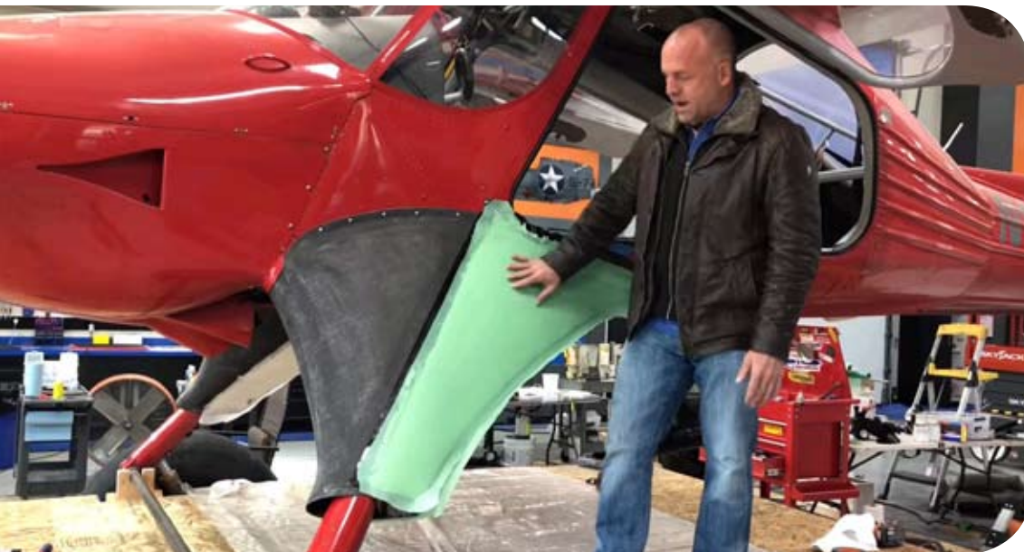
Rys. 3. Zbiorniki paliwa w osłonach goleni podwozia głównego. Fot. Mike Patey
