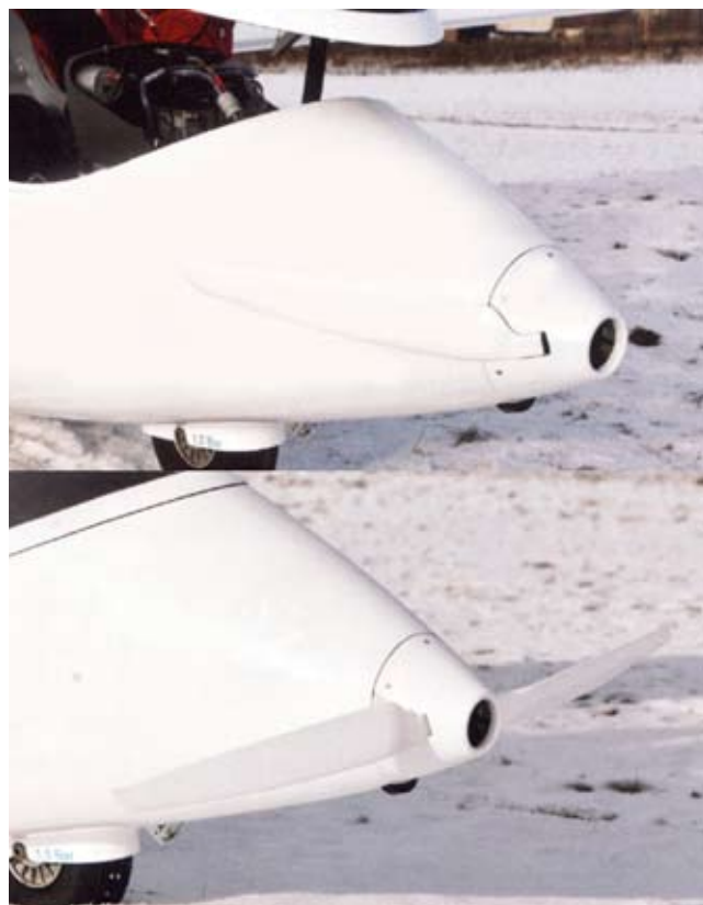
Rys. 11. Złożone i rozłożone śmigła o średnicy 1,2 m w dziobie szybowca PW-X10. Fot. ZS Jeżów
