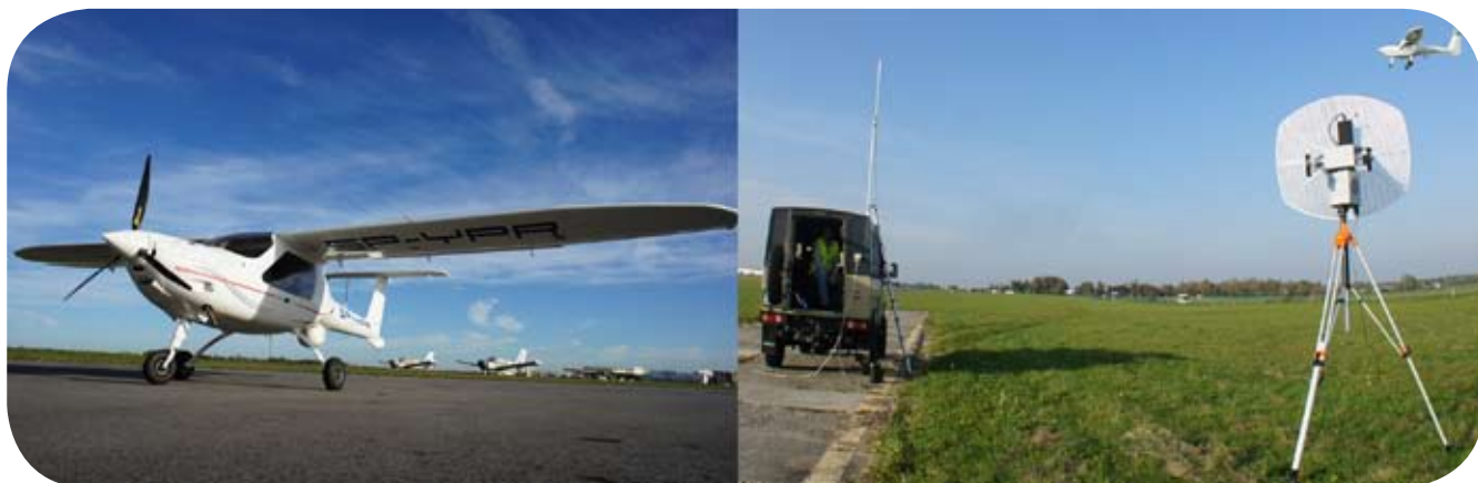
Rys. 7. Samolot MP-02 Czapka jako demonstrator opcjonalnie pilotowanego samolotu oraz mobilna stacja planowania i kierowania lotem w projekcie LOT. Fot. D. Kordos, PRz
