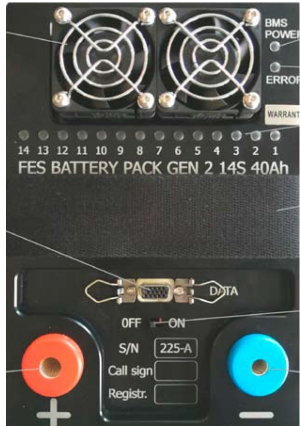
Rys.13. Akumulator - bateria firmy Kokam GEN2 14S w widoku z góry. Widoczne wiatraki chłodzące, złącza monitoringu i wejścia kabli. Fot. LZ Design
