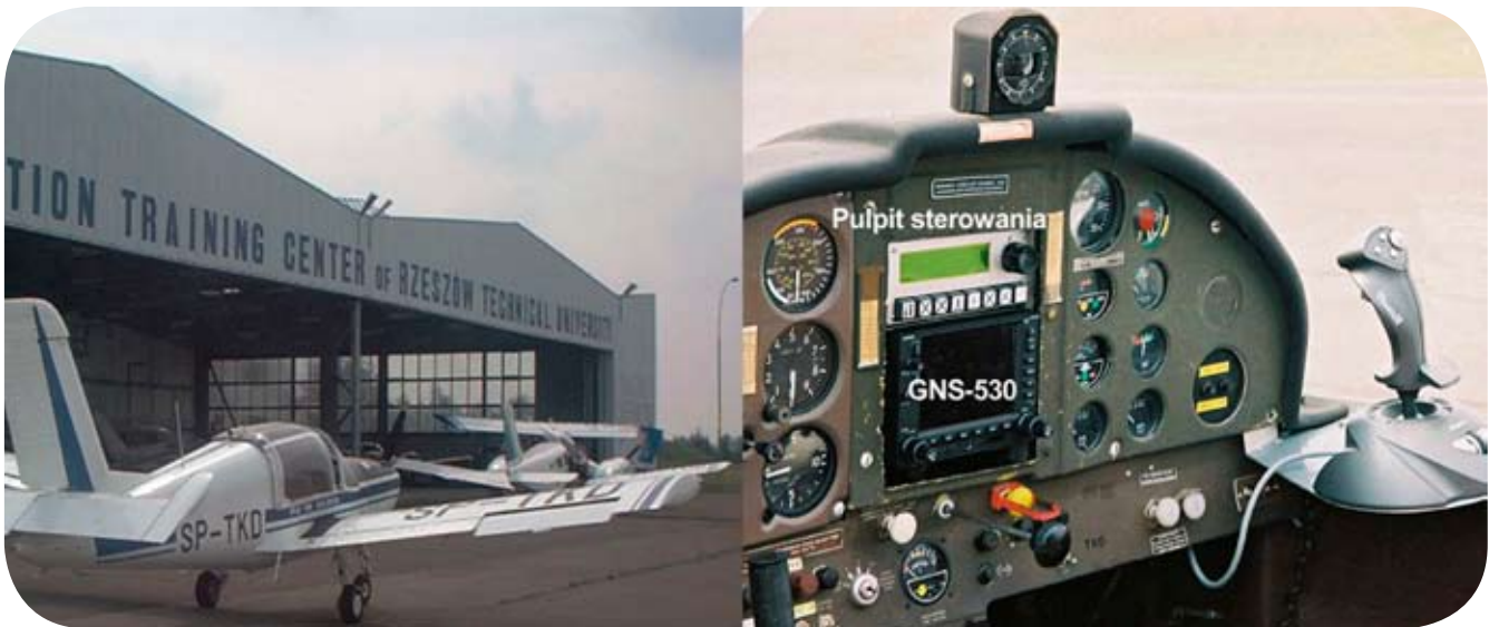
Rys. 5. Samolot PZL-110 Koliber oraz elementy systemu SPS-1A zabudowane w kabynie pilota (fot. A. Tomczyk, PRz)
