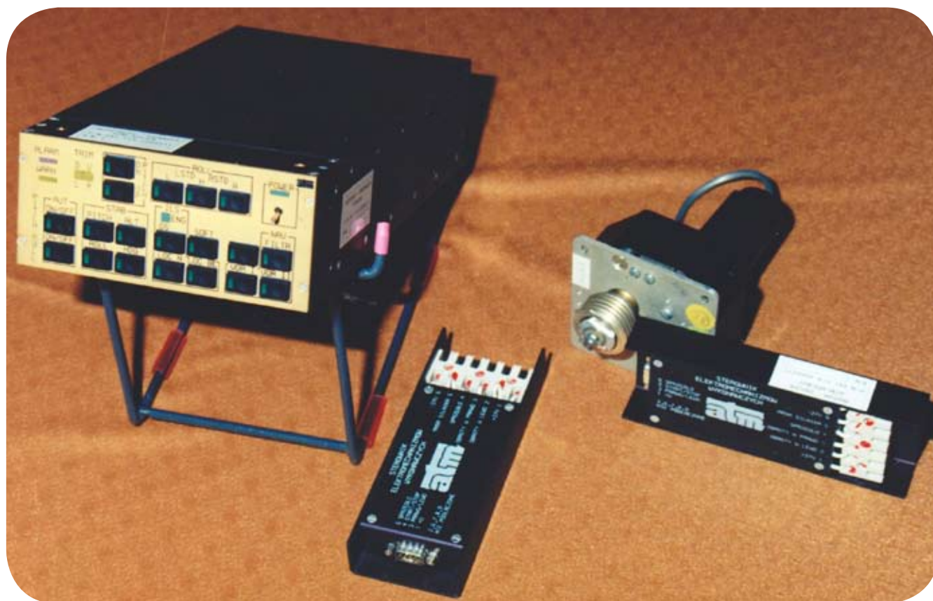
Rys. 3. Moduł główny autopilota APC-1P z pulpitem sterowania, mechanizm wykonawczy oraz dwa sterowniki ze wzmacniaczami mocy. Fot. M. Misiakiewicz, PRz.
