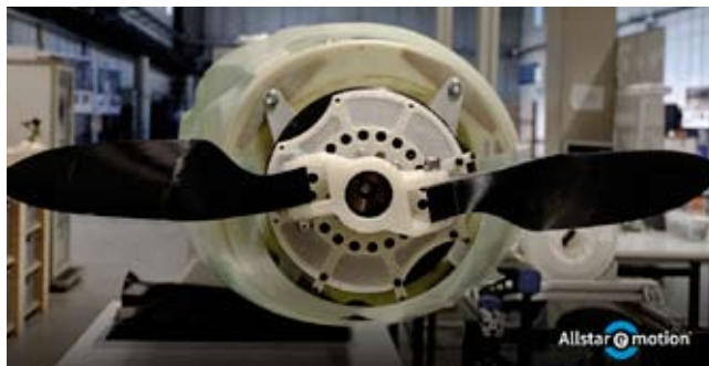
Rys. 3. Autorski silnik firmy Allstar PZL Gliders dla szybowca SZD-55. Fot. Allstar PZL Gliders
