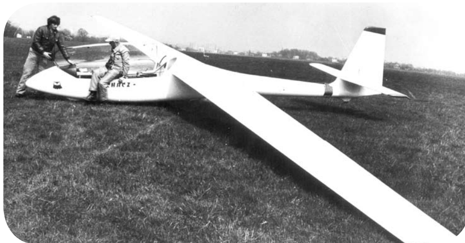
Fot. 2. SZD-50 Puchacz podczas prób korkociągowych. Pierwszy z lewej pilot doświadczalny SZD Zdzisław Bylok, obok pilot Kazimierz Duc. Z tyłu kadłuba widoczny zamocowany worek ze śrutem. Fot. CAF
