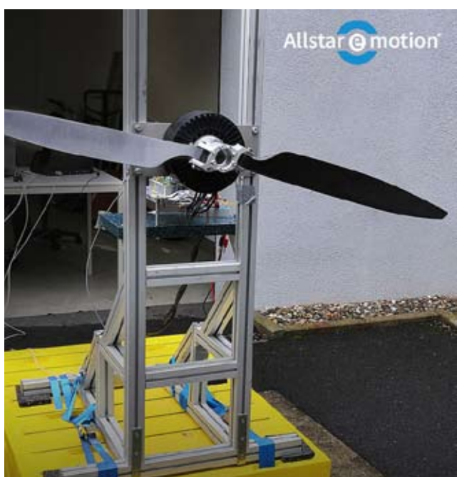
Rys.5. Silnik firmy Allstar PZL Gliders podczas prób na hamowni. Fot. Allstar PZL Gliders
