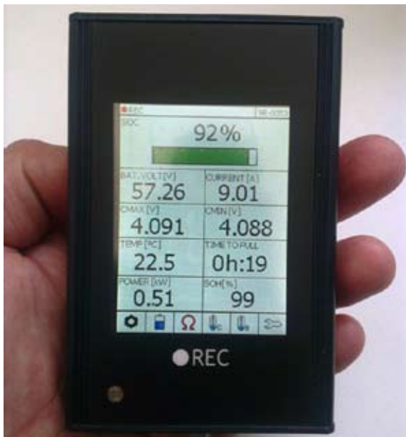
Rys. 15. Nowoczesny komputer pokładowy - w formie tabletu - monitorujący napęd FES. Fot LZ Design
