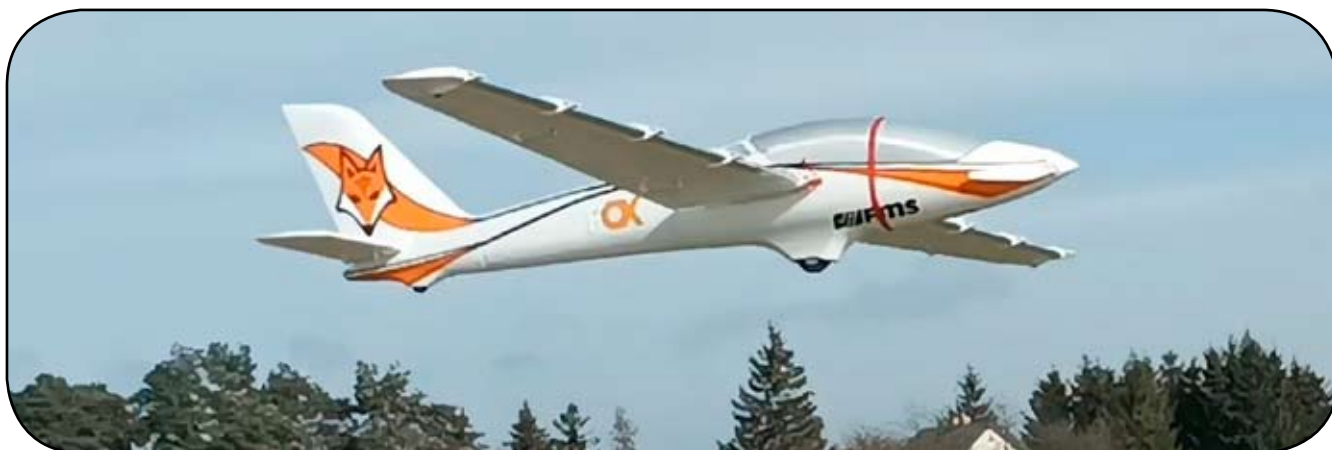
Rys. 9. FMS Fox 3000 z uruchomionym układem generowania jonów w locie ślizgowym
