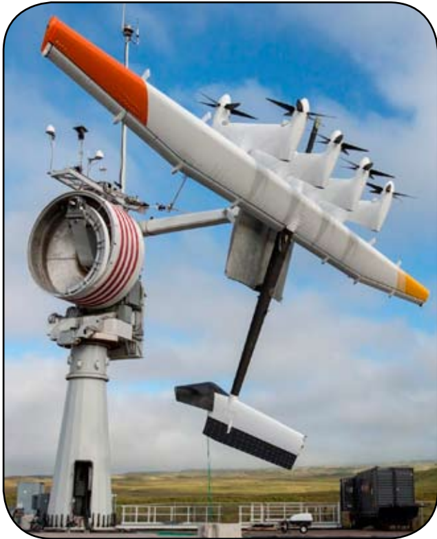
Rys. 11. Latawiec Makani M600 na stacji bazowej naziemnej
