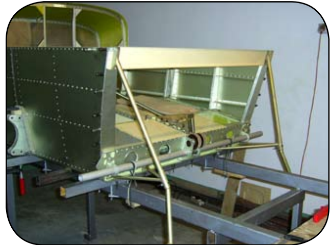
Rys. 2. Widok na wręgę skośną
