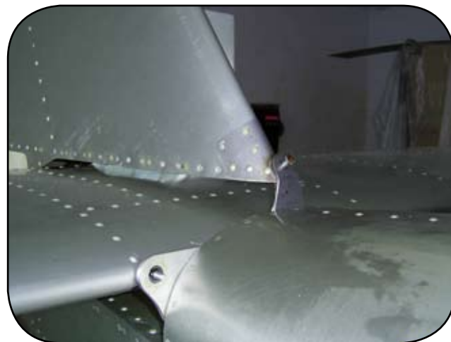
Rys. 8. Mocowanie usterzeń do kadłuba
