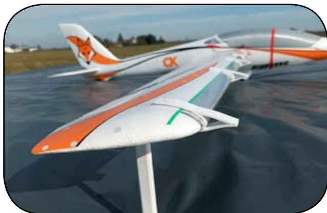
Rys. 6. Skrzydło modelu motoszybowca z układem elektrod
