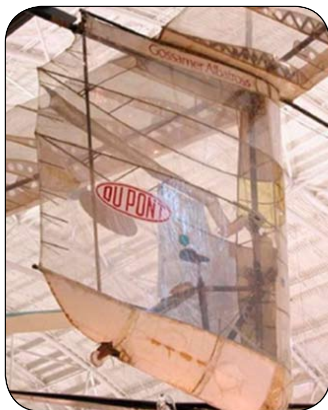
Rys. 5. Gondola pilota mięśniolotu Gossamer Albatros od tyłu
