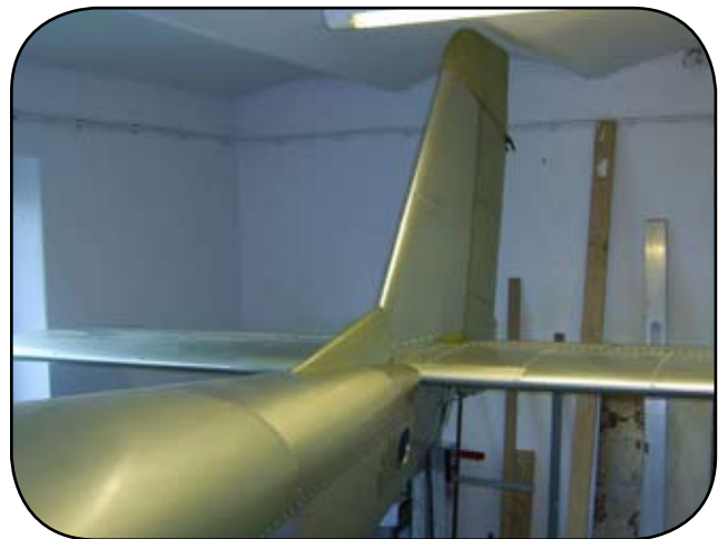
Rys. 10. Usterzenia po zabudowie na kadłubie
