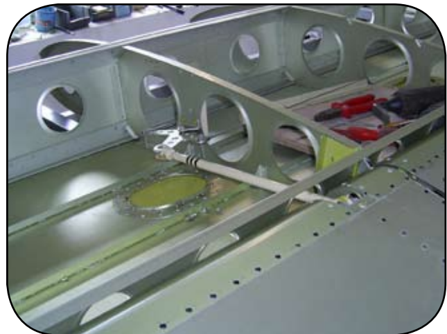
Rys. 11. Sterowanie lotką w skrzydle
