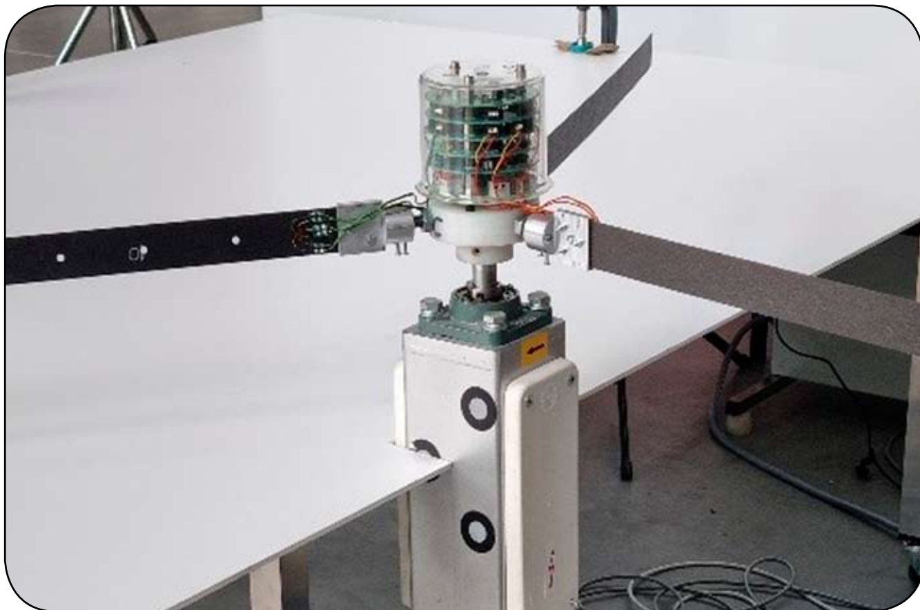
Model wirnika trójłopatowego – stanowisko laboratoryjne
