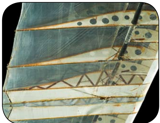
Rys. 3. Konstrukcja żeber mięśniolotu Gossamer Albatros
