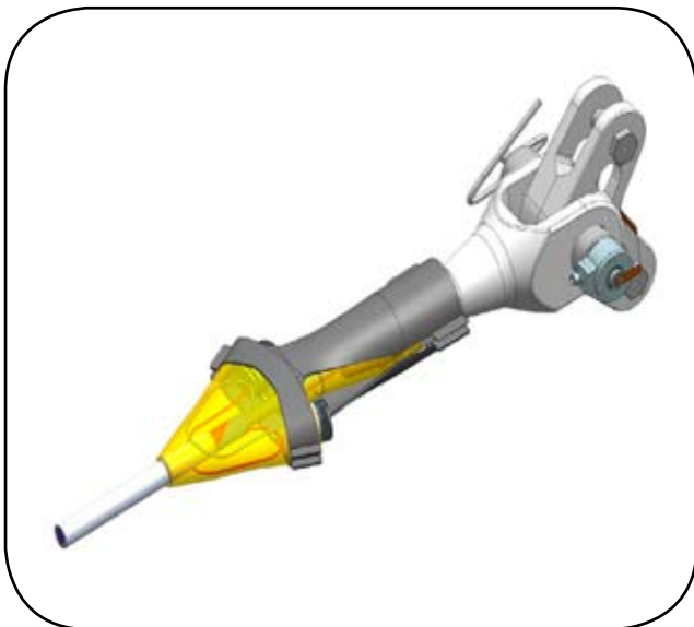
Rys. 9. Widok zakończenia uwięzi
