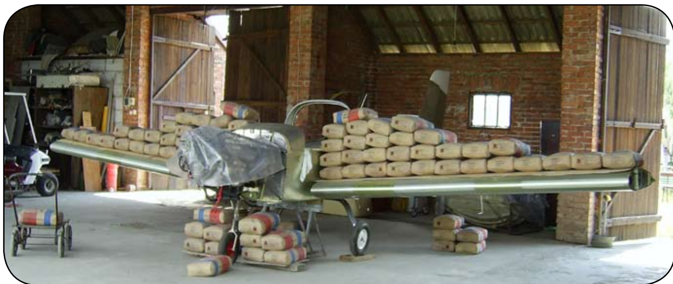
Rys. 9. Jedna z prób zginania skrzydła
