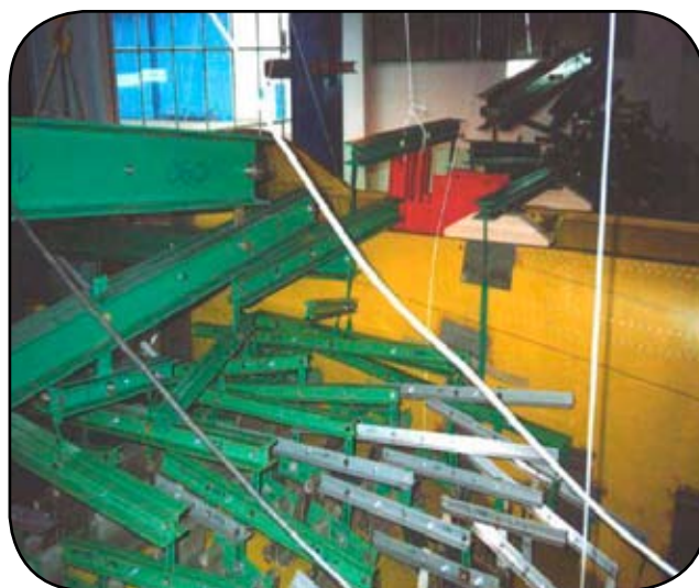
Rys. 14. Próba statyczna skrzydła- widoczne liczne ceowniki układu dźwigniowego. Fot. Jerzy Mularczyk
