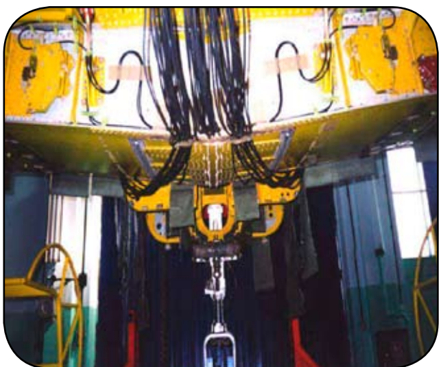
Rys. 13. Liczne kable od tensometrów w centroplacie samolotu Orlik. Fot. Jerzy Mularczyk
