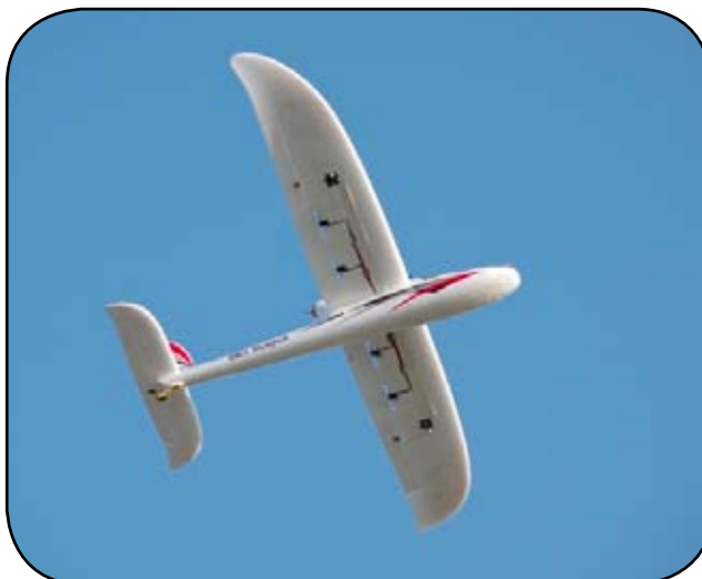
Rys. 4. Model motoszybowca z napędem PROPWING podczas prób w locie
