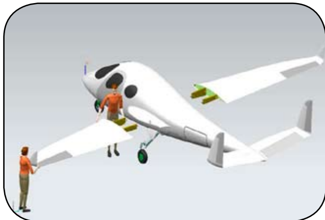
Rys. 23. Wizualizacja komputerowa samolotu Flaris – montaż skrzydeł. Fot. Metal Master
