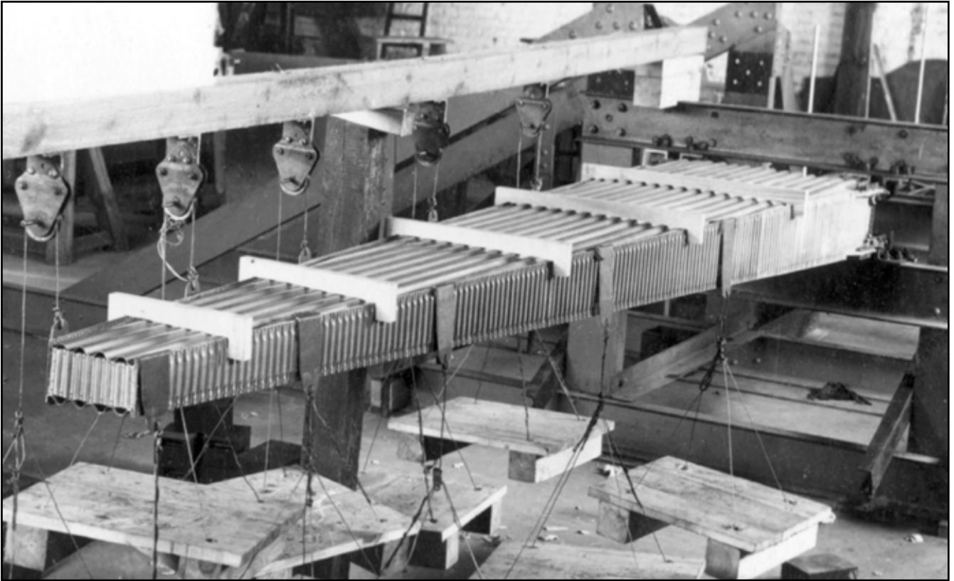
Rys. 6. Keson Misztala podczas prób statycznych w Instytucie Badań Technicznych Lotnictwa. Fot. IBTL
