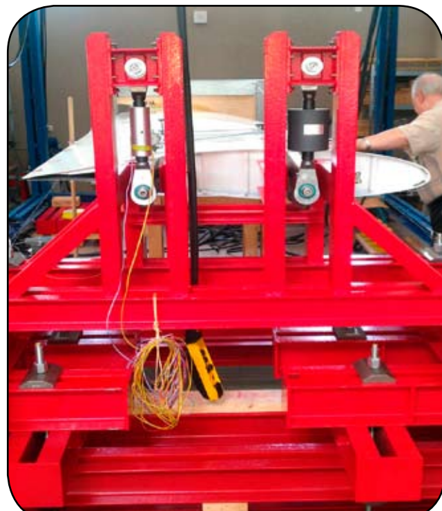
Rys. 28. Pomiar kąta skręcenia skrzydła. Fot. WAT
