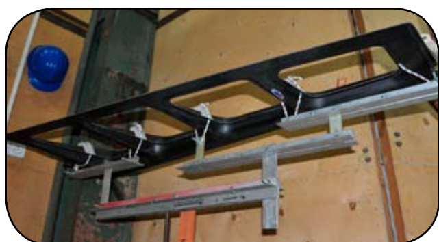
Rys. 21. Próba statyczna steru kierunku w Politechnice Warszawskiej. Fot. PW
