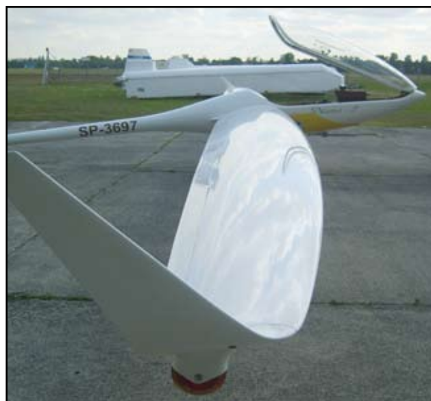
Rys. 11. Eliptyczne skrzydło Diany 2 zakończone wingletem – dzieło prof. Krzysztofa Kubryńskiego. Fot. Tomasz Murawski
