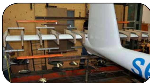
Rys. 22. Badanie usterzenia poziomego w Politechnice Warszawskiej. Fot. PW
