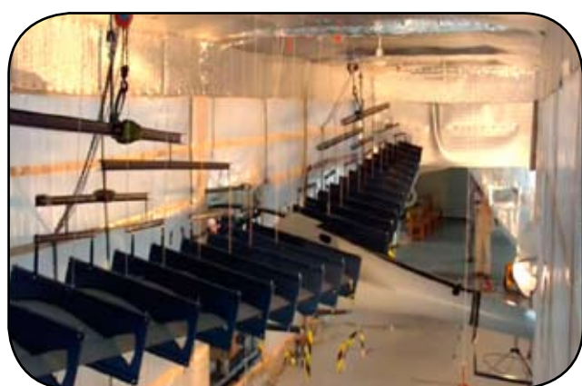
Rys. 18. Próba statyczna skrzydła na wyrwanie – zdjęcie z lewej przed próbą i po prawej w czasie maksymalnego obciążenia. Fot. Jerzy Mularczyk
