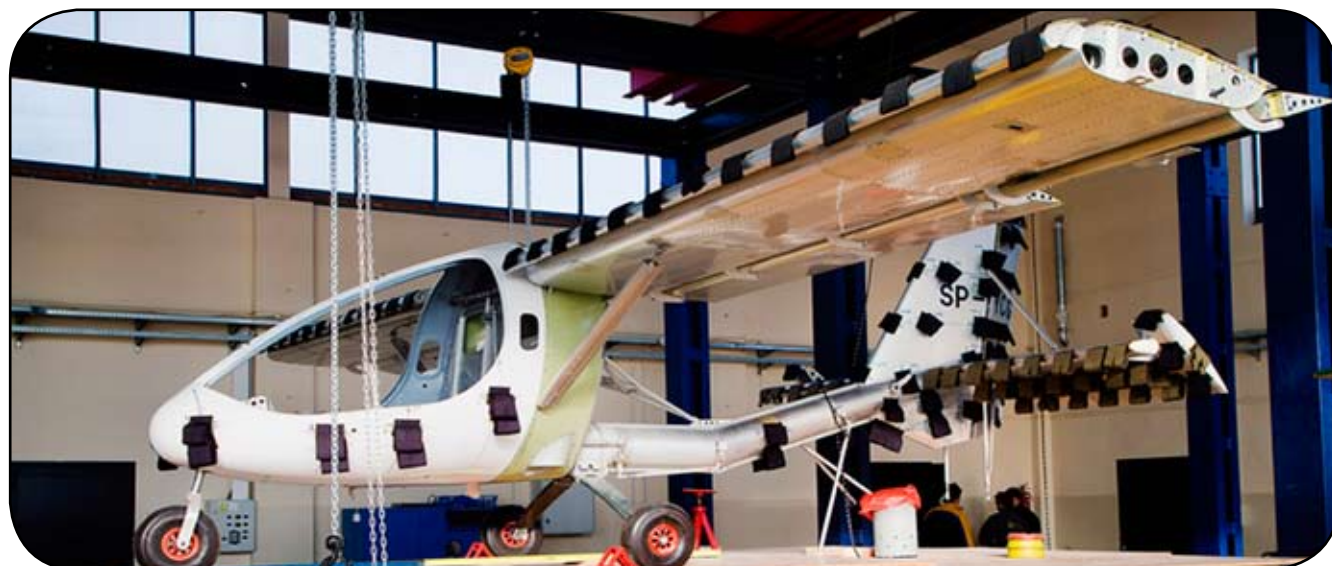
Rys. 29. Samolot OSA podczas próby statycznej. Fot. Andrzej Mroczek
