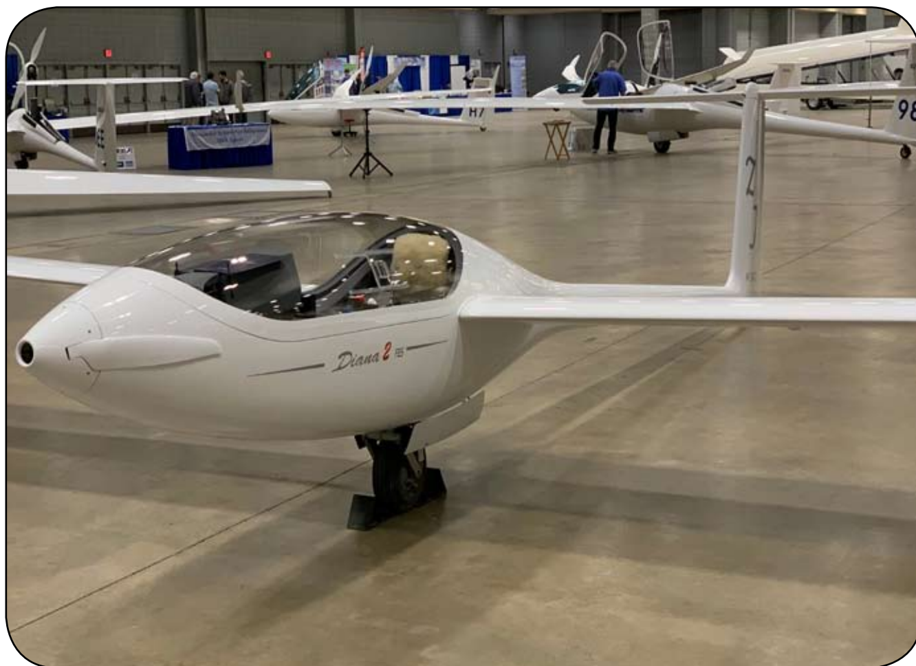
Rys. 8. Szybowiec Diana 2 FES na wystawie statycznej. Widoczne śmigła napędu FES. Fot. Avionic
