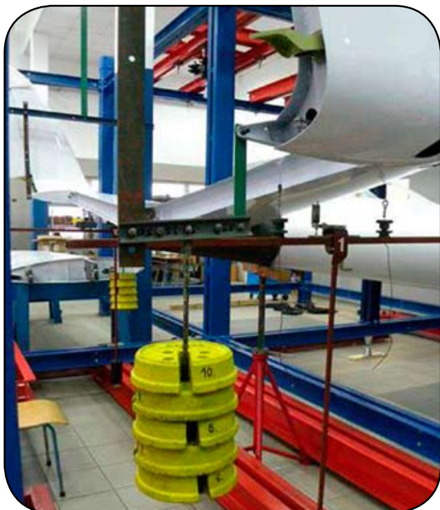
Rys. 27. Próba statyczna usterzenia poziomego – widoczne obciążenie. Fot. WAT
