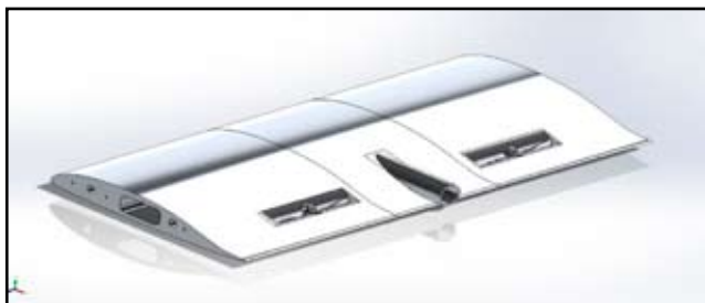
Rys. 5. Komputerowy rysunek modelu do badań w tunelu aerodynamicznym
