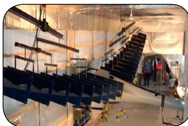
Rys. 18. Próba statyczna skrzydła na wyrwanie – zdjęcie z lewej przed próbą i po prawej w czasie maksymalnego obciążenia. Fot. Jerzy Mularczyk
