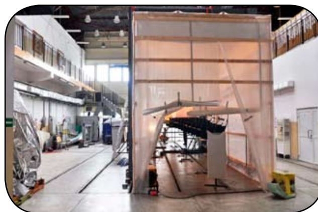
Rys. 17. Motoszybowiec w Politechnice Rzeszowskiej – widoczna ogrzewana „klatka wytrzymałościowa”. Fot. Jerzy Mularczyk
