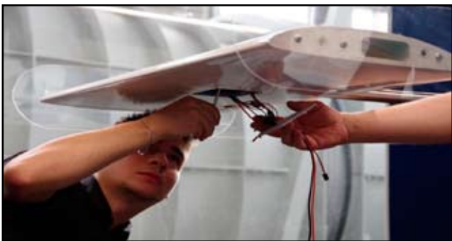
Rys. 8. Montaż modelu skrzydła w tunelu aerodynamicznym
