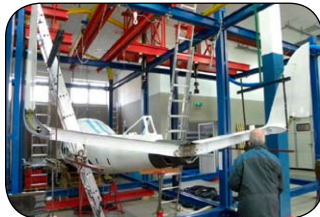
Rys. 24. Samolot Flaris w specjalnej „klatce wytrzymałościowej” podczas prób statycznych. Fot. WAT
