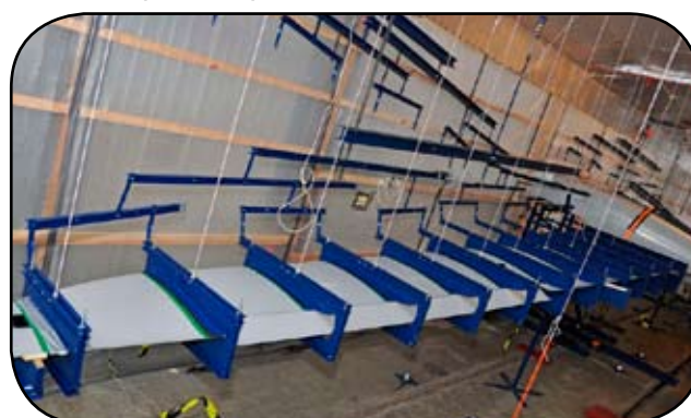
Rys. 20. Skrzydło w czasie próby na ujemne przeciężenia. Fot. Jerzy Mularczyk
