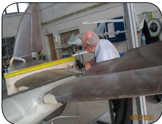
Rys. 25. Obejma na profilu usterzenia – pomiar naprężeń. Fot. WAT
