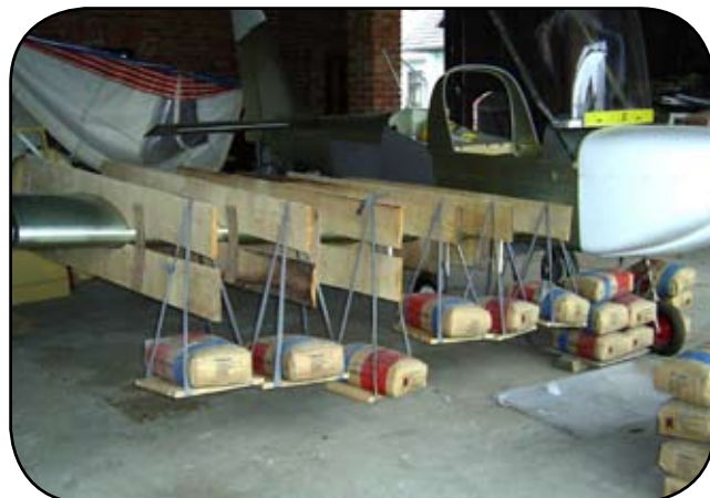
Rys. 10. Próba wytrzymałości skrzydła na skręcanie
