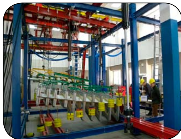
Rys. 26. Próba statyczna skrzydła na wyrwanie. Fot. WAT
