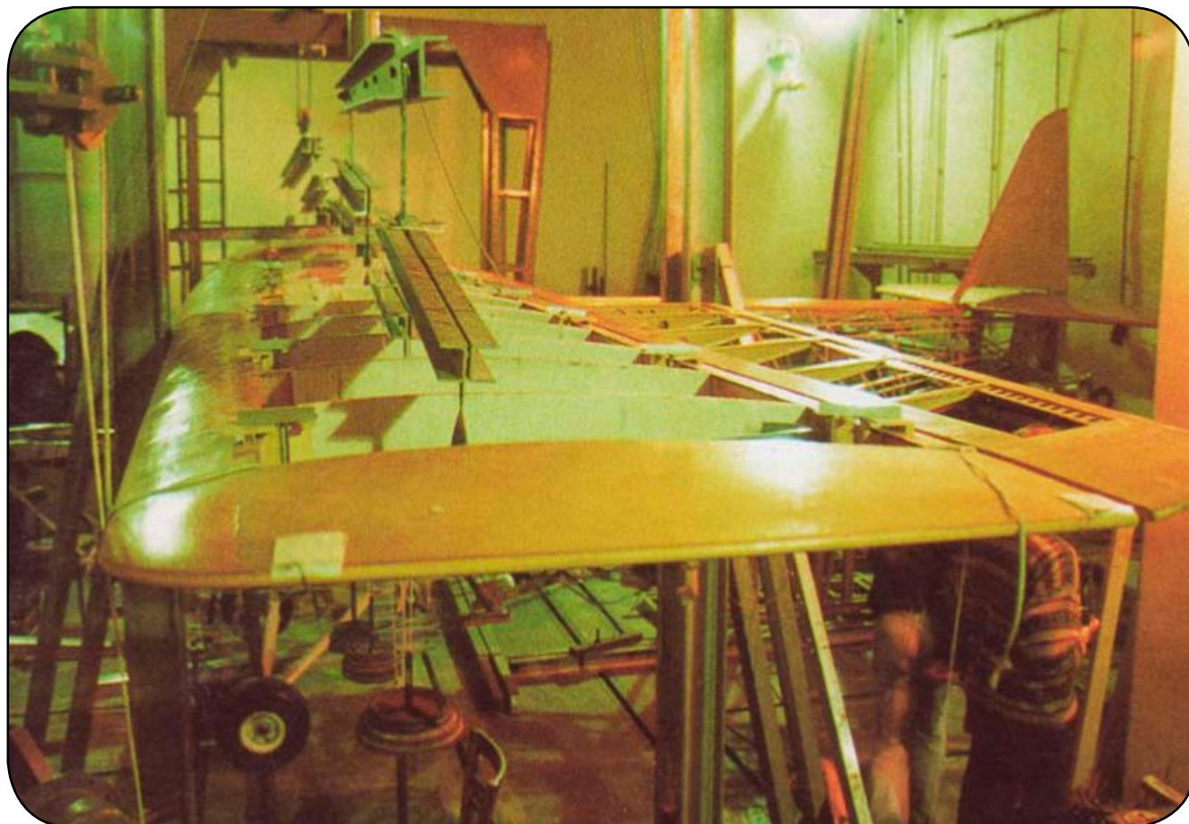
Rys. 1. Samolot RWD-5R podczas próby statycznej skrzydła w „klatce wytrzymałościowej” w Bielsku-Białej. Fot. Jacek Mainka
