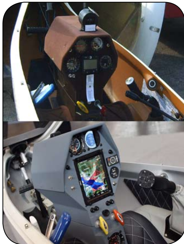
Rys. 5. Widoczna na dole zmodernizowana wersja tablicy przyrządów w Dianie 2. Fot. Avionic
