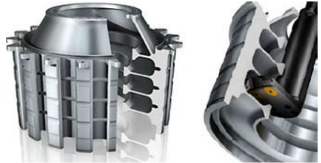
Rys. 11. Obróbka wewnętrznych wybrań na przykładzie tarczy wentylatora lotniczego (© SANDVIK)
