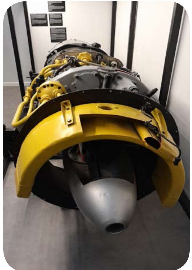
Rys. 9. Niemiecki silnik odrzutowy Junker Jumo 004, napędzający samolot Me-262. Fot. Tomasz Murawski
