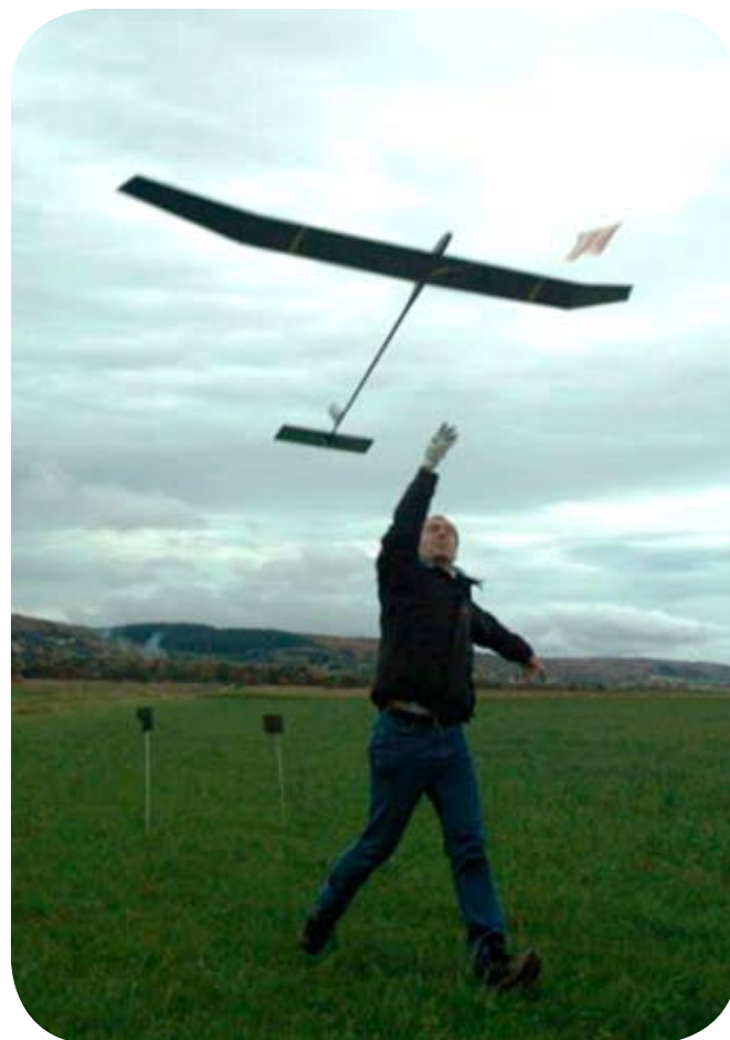
Rys. 7. Początek holowania modelu szybowca klasy F1A ze skrzydłem i rurą kadłuba wykonanymi z zastosowaniem technologii Thinpreg
