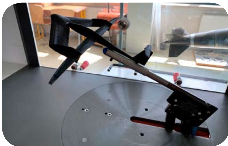
Rys. 5. Model zespołu holownik-szybowiec w komorze tunelu aerodynamicznego
