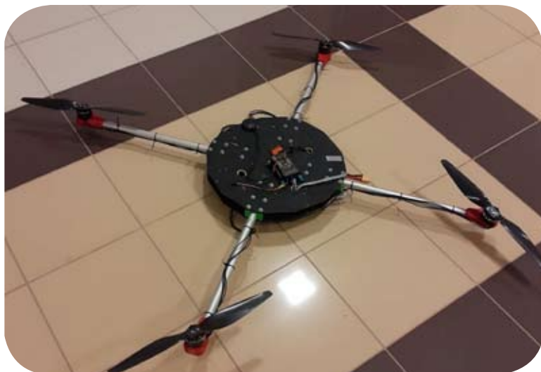
Rys. 7. Pierwsza wersja ramy bezzałogowego paczkomatu
