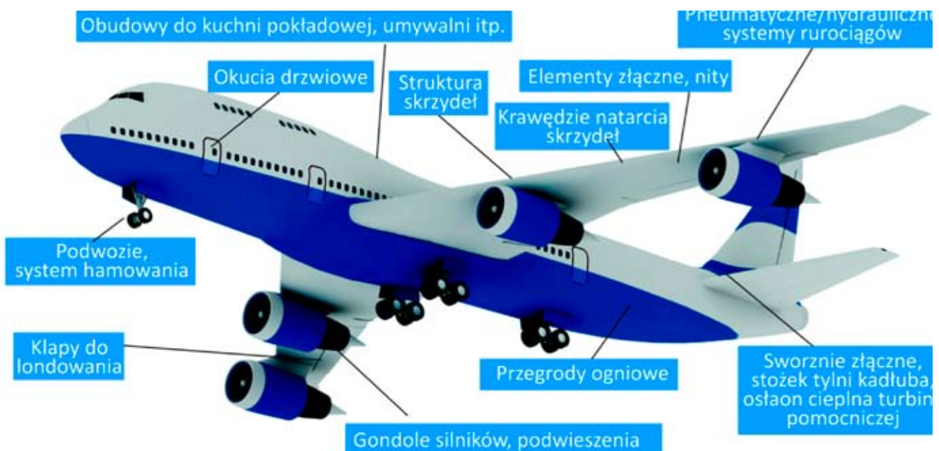
Rys. 18. System wewnętrzno i zewnętrzno smarowania [13]
