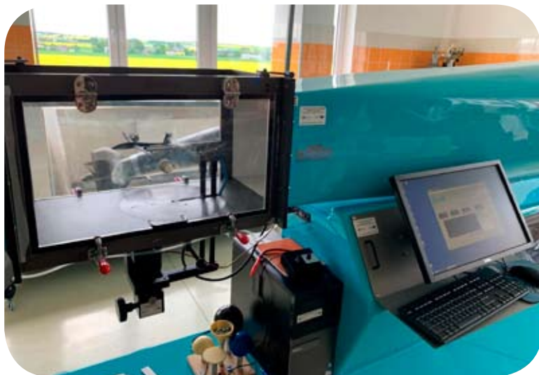
Rys. 4. Tunel aerodynamiczny Aerolab w PANS Chełm, z modelem wewnątrz komory pomiarowej
