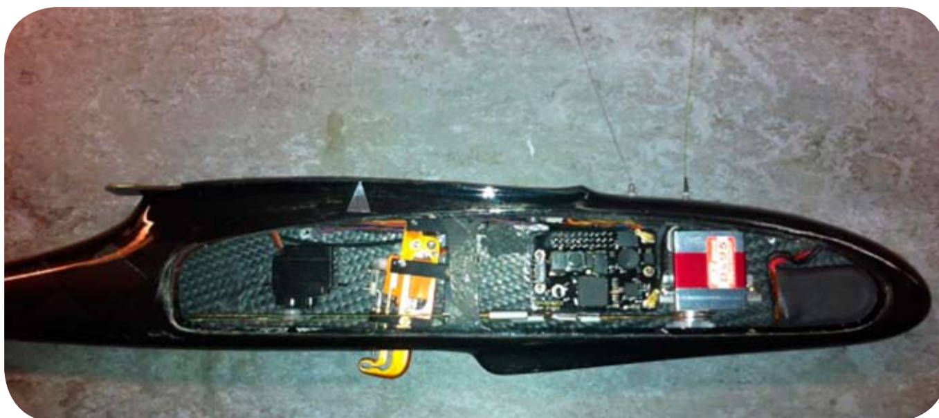
Rys. 1. Kadłub modelu klasy F1A wykonany z laminatu węglowo-epoksydowego
