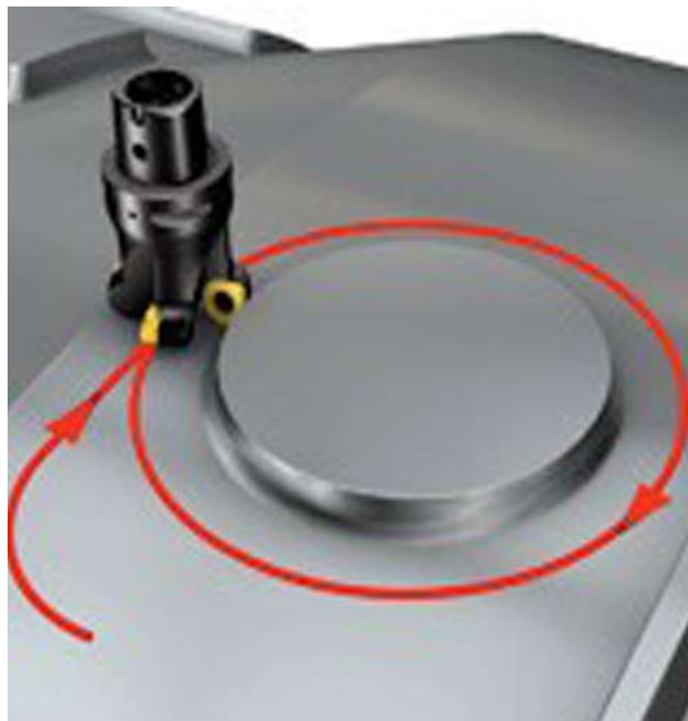
Rys. 13. Frezowanie zgrubne powierzchni wokół występu (© SANDVIK)
