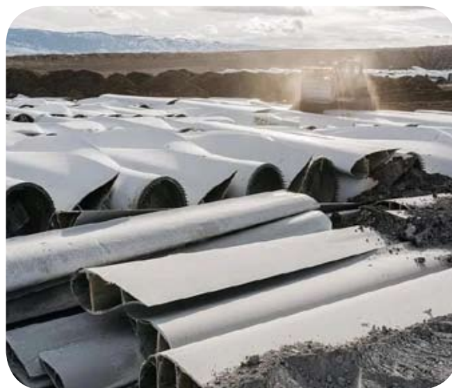
Rys. 1. Łopaty turbin wiatrowych poddane składowaniu [1]
