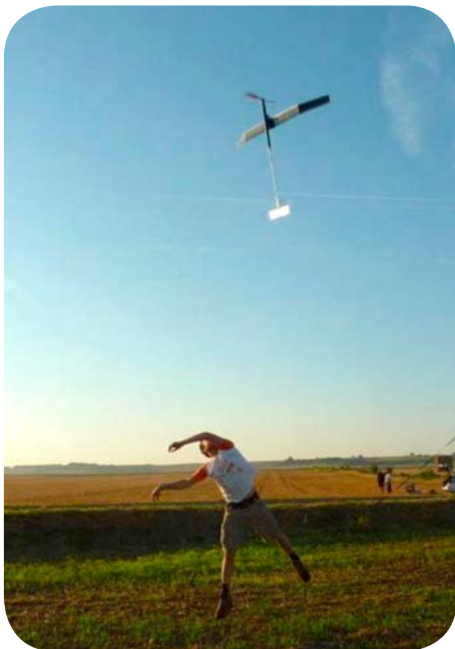
Rys. 3. Start modelu z napędem gumowym klasy F1B Kevina Lamersa. Skrzydło modelu z pełnym poszyciem w technologii Thinpreg
