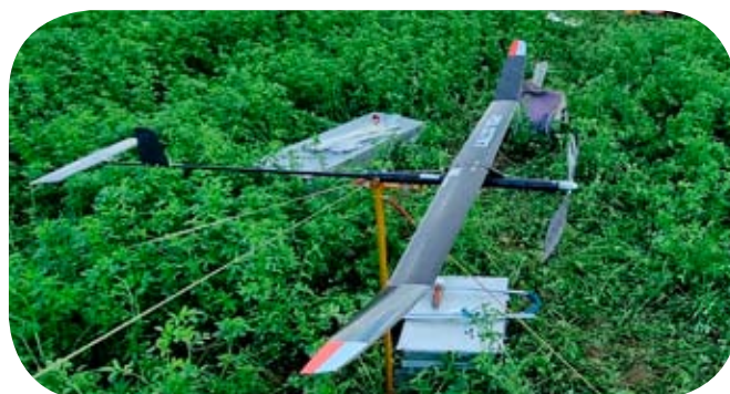
Rys. 10. Model swobodnie latający z napędem gumowym Adama Krawca. Skrzydła oraz rura kadłuba wykonane z zastosowaniem ThinPreg
