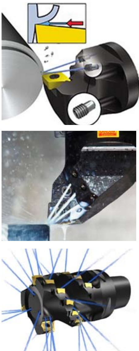
Rys. 17. Przykłady narzędzi z chłodzeniem wysokociśnieniowym (© SANDVIK)
