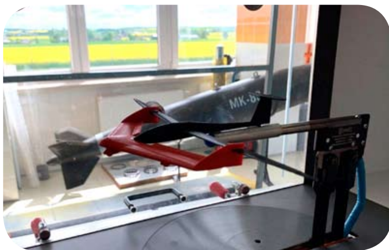
Rys. 6. Badania zespołu przy różnych wartościach kąta zaklinowania pomiędzy skrzydłem holownika i skrzydłem szybowca
