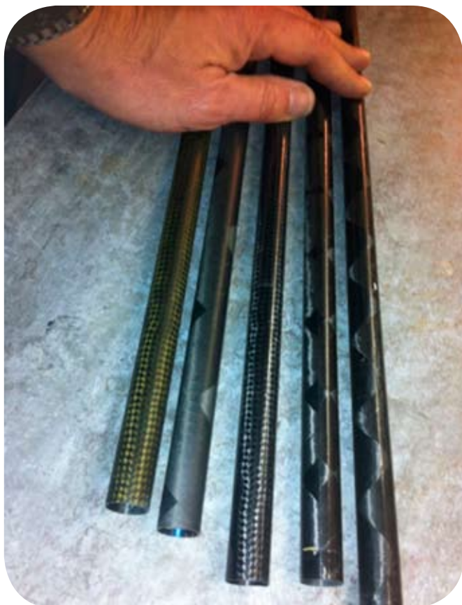
Rys. 8. Porównanie rur do budowy kadłuba modelu, zwykłe – wykonane z klasycznej tkaniny węglowej (na zdjęciu z lewej) oraz z zastosowaniem ThinPreg (z prawej)
