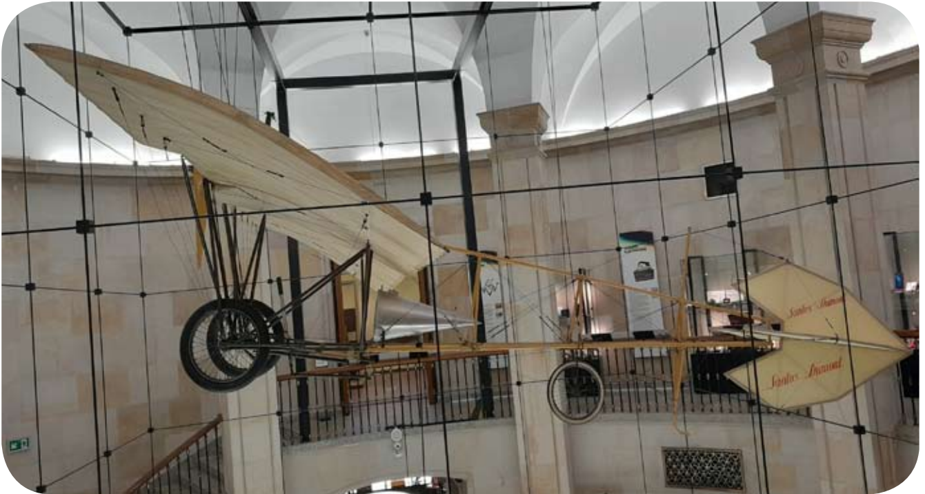
Rys. 2. Kopia pionierskiego samolotu Santos Dumont N. 20 „Demoiselle” w widoku z boku. Pilot siedział pod skrzydłem. Widoczny stożkowy zbiornik paliwa. Fot. Tomasz Murawski
