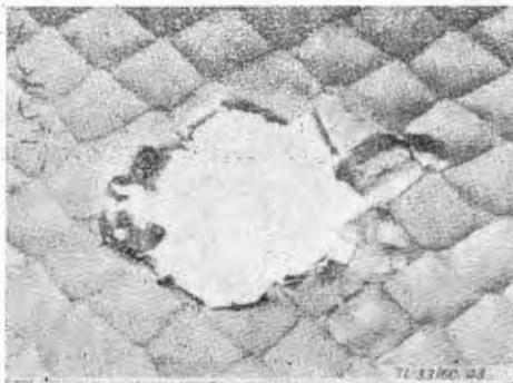
Rys. 3. Płyta przekładkowa przebita pociskiem kalibru 20 mm
