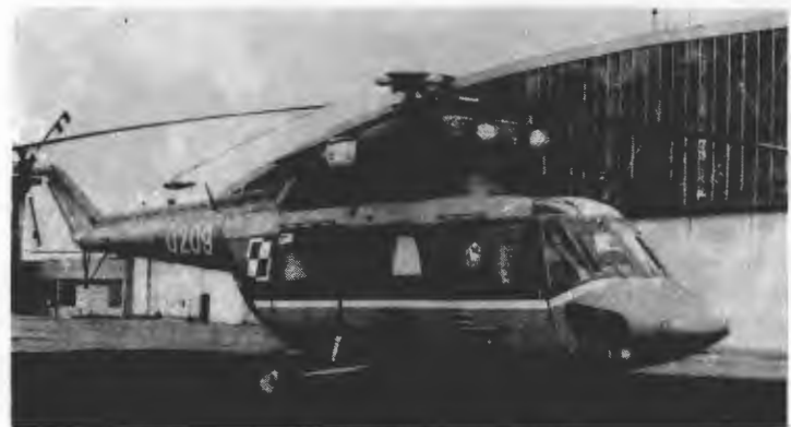
12-miejscowy śmigłowiec wielozadaniowy PZL Sokół ● The 12-seat PZL Sokół multipurpose helicopter. Fot. L. Zielaskowski
