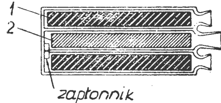
Rys. 9. Silnik startowy 1 rozmieszczony jest wokół silnika marszowego 2
