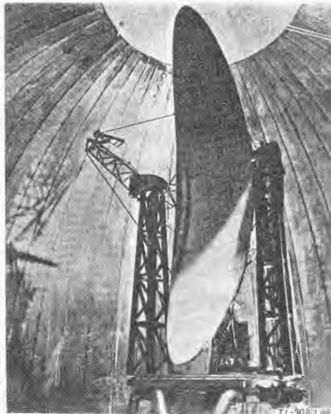
Rys. 8. Antena wysokościomierza radarowego typu AN/FPS-25. Aparatura tego radaru zawiera ok. 3500 lamp elektronowych
