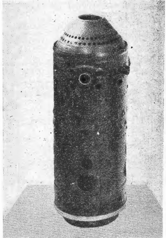
Rys. 3. Rura żarowa komory spalania angielskiego silnika „Proteus”
