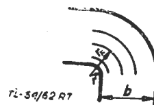
Rys. 7. Schematyczne przedstawienie kolanka z kierownicami współśrodkowymi
