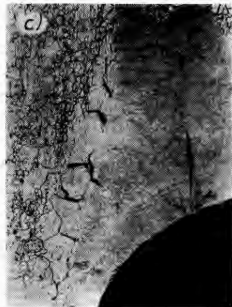
Rys. 10. Struktura złącza spawanego w elemencie próbnym wykonanym w ZSRR: a) pow. 10 X; b) i c) w strefie pęknięć — pow. 50 X
