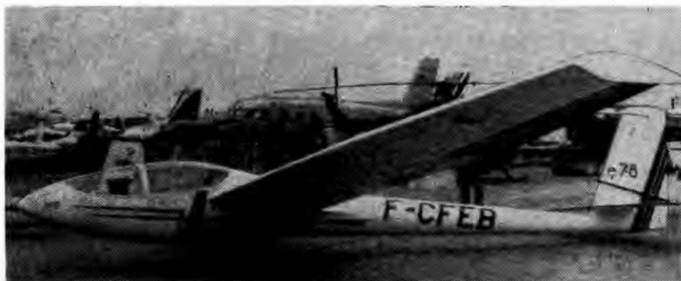
Rys. 2. Francuski szybowiec dwumiejscowy Siren E-78 Silene z miejscami obok siebie
