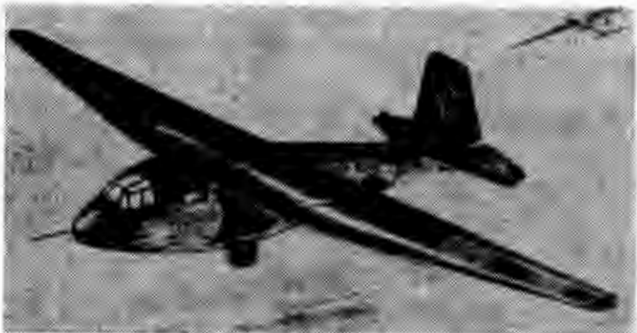
Rys. 6. Radziecki szybowiec Gribowskiego G-11 (GR-29) z 1941 r.
