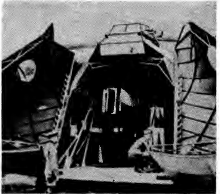
Rys. 17. Otwierany przód szybowca Me-321
