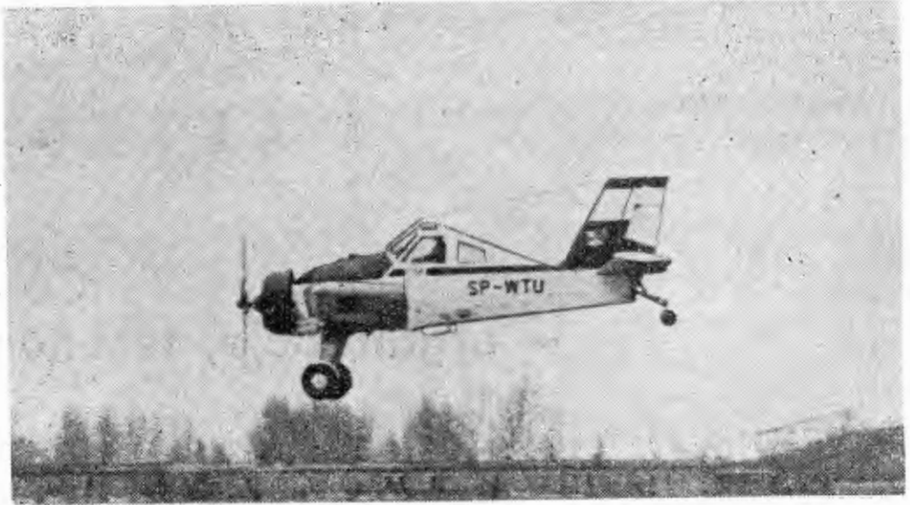
PZL-106AR Kruk (SP-WTU) z silnikiem reduktorowym PZL-3
