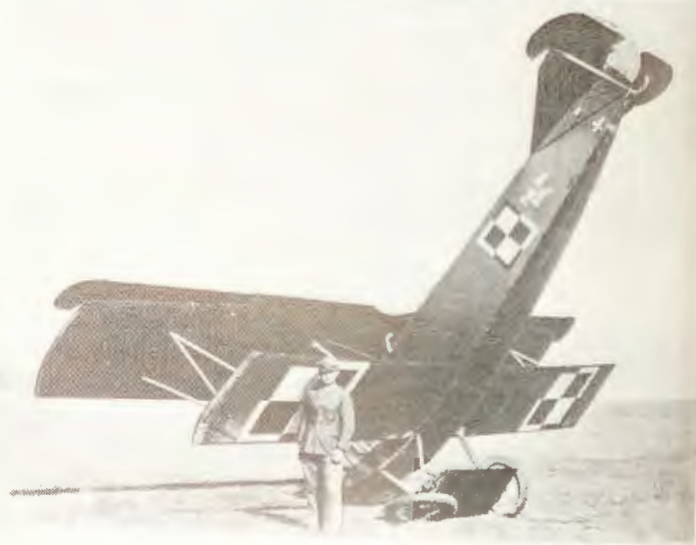
Nawet na równym lotnisku zbyt „twarde” lądowanie może spowodować uszkodzenie podwozia i postawienie samolotu „na nosie” Myśliwski Fokker D. VII nr 530/18 w połowie lat dwudziestych Zdjęcia ze zbiorów A. Glas
