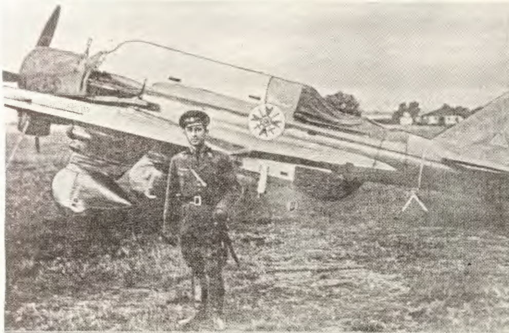
P.24B w próbach na Okęciu w 1936 r. Osłona kabiny była pozbawiona bocznych szyb dla zapewnienia dobrej widoczności w niekorzystnych warunkach atmosferycznych (Ze zbiorów R. Kaczkowskiego)
