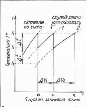
Rys. 36. Pobór mocy w zależności od rodzaju użytego czynnika smarująco-chłodzącego a. przy toczeniu, b. przy gwintowaniu. Rys. 37. Wpływ chłodzenia i smarowania przy obróbce wiórowej na obniżenie temperatury procesu i możliwość zwiększenia szybkości skrawania.
