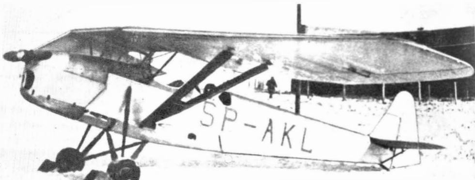
SP-AKL ze zwężonymi końcówkami skrzydeł i silnikiem Walter Junior ● SP-AKL with narrow wing tips and Walter Junior engine
