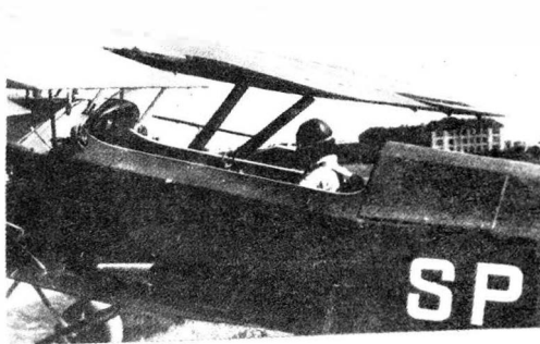
Wannowa kabina RWD-8pws po wyjęciu przegrody ● RWD-8pws' bathtub-type cockpit with its fairing removed
