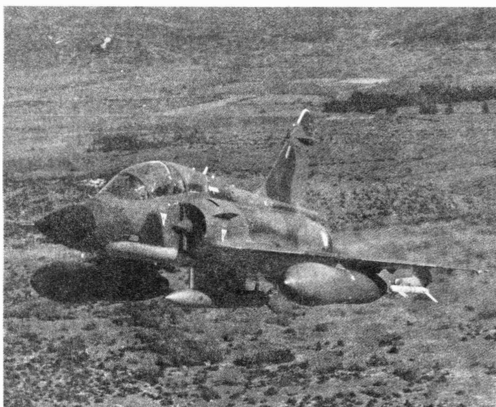
Dassault-Breguet Mirage 2000B uzbrojony w pocisk powietrze-ziemia średniego zasięgu Aérospatiale ASMP (Air-Sol Moyen Portée) pod kadłubem i dwa pociski Matra Magic 2 pod skrzydłami ● Dassault-Breguet Mirage 2000B carrying the Aérospatiale ASMP (Air-Sol Moyen Portée) missile and two Matra Magic 2 air-to-air missiles
