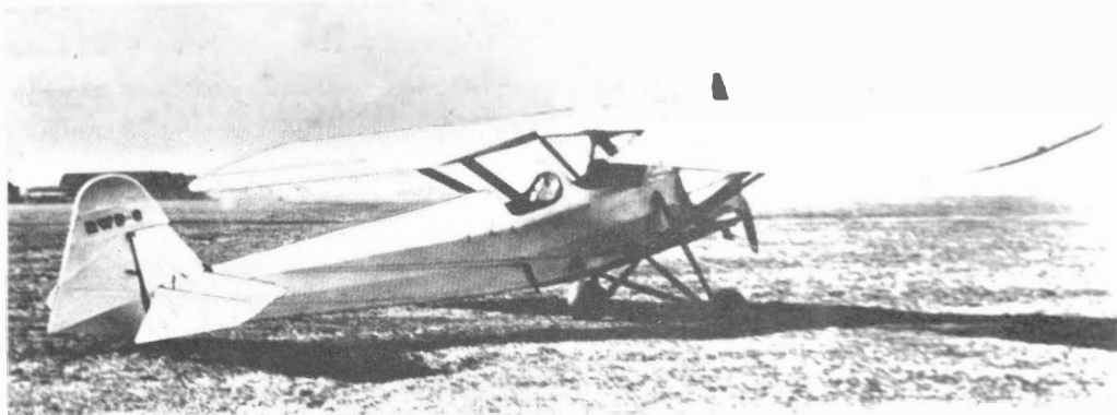
Prototyp z płatem pierwszego rodzaju i silnikiem Gipsy ● RWD-8 prototype with initial wings and Gipsy engine
