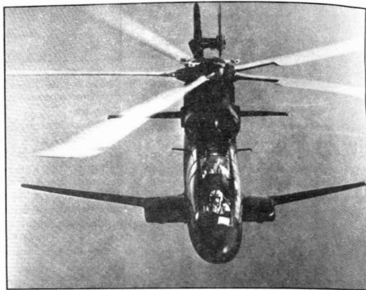
Ostatnia faza prób Blackhawka — śmigłowiec wyposażony w otunelowany wentylator zamiast śmigła ogonowego
