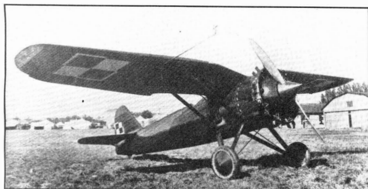
Prototyp PZL P.7/I z wąskim pierścieniem osłony silnika ● PZL P.7/I prototype equipped with narrow Townend ring
