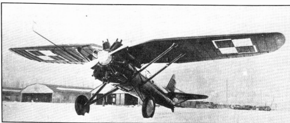
Pierwszy prototyp PZL P.7/I z oddzielnymi osłonami na każdy cylinder ● PZL P.7/I prototype with cowlings over each engine cylinder
