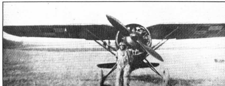
Drugi prototyp PZL P.7 służący jako wzorzec wersji seryjnej, podczas służby w Dęblinie, z uzbrojeniem na zastrzałach i białymi polami szachownic ● Second prototype of PZL P.7, production standard machine, while in service at Dęblin, with its guns mounted on brace struts; note white areas of Polish national insignia
