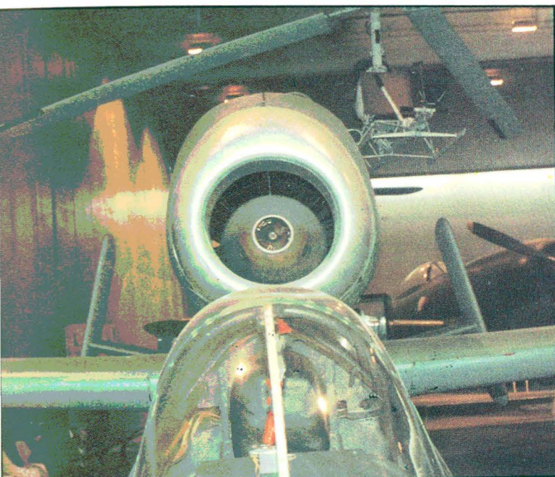
Szczegóły konstrukcji samolotu He 162A-2 – eksponatu Musée de l'Air na lotnisku Le Bourget w Paryżu; kolejno współzegarowo: osłona kabiny, usterzenie pionowe, silnik BMW 003 w widoku z tyłu, podwozie główne, podwozie przednie, silnik i kabina pilota w widoku z przodu. Zdjęcia: Wojciech J. Gawrych
